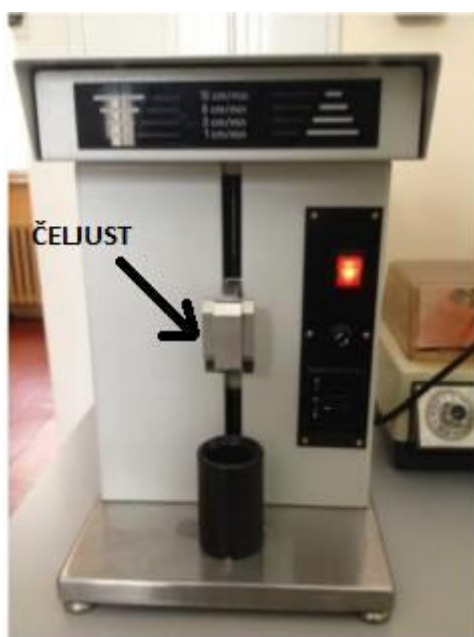
Slika 11. Uređaj za nanošenje prevlaka na predmetna stakalca
