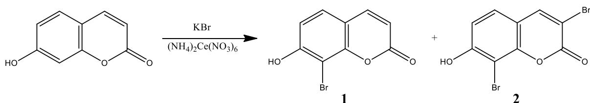
Shema 1. Sinteza spojeva **1** i **2** reakcijom bromiranja
