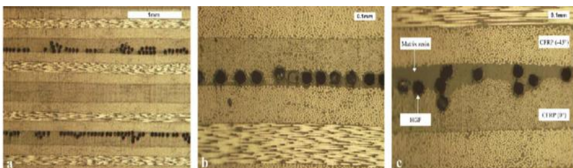
Slika 8. Šuplja vlakna ugrađena u kompozite [33]
