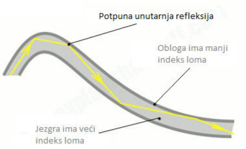
Slika 19. Optičko vlakno (svjetlovod)
