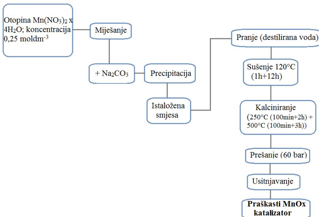
**Slika 3.1.** Shematski prikaz pripreme praškastog MnO<sub>x</sub> katalizatora
