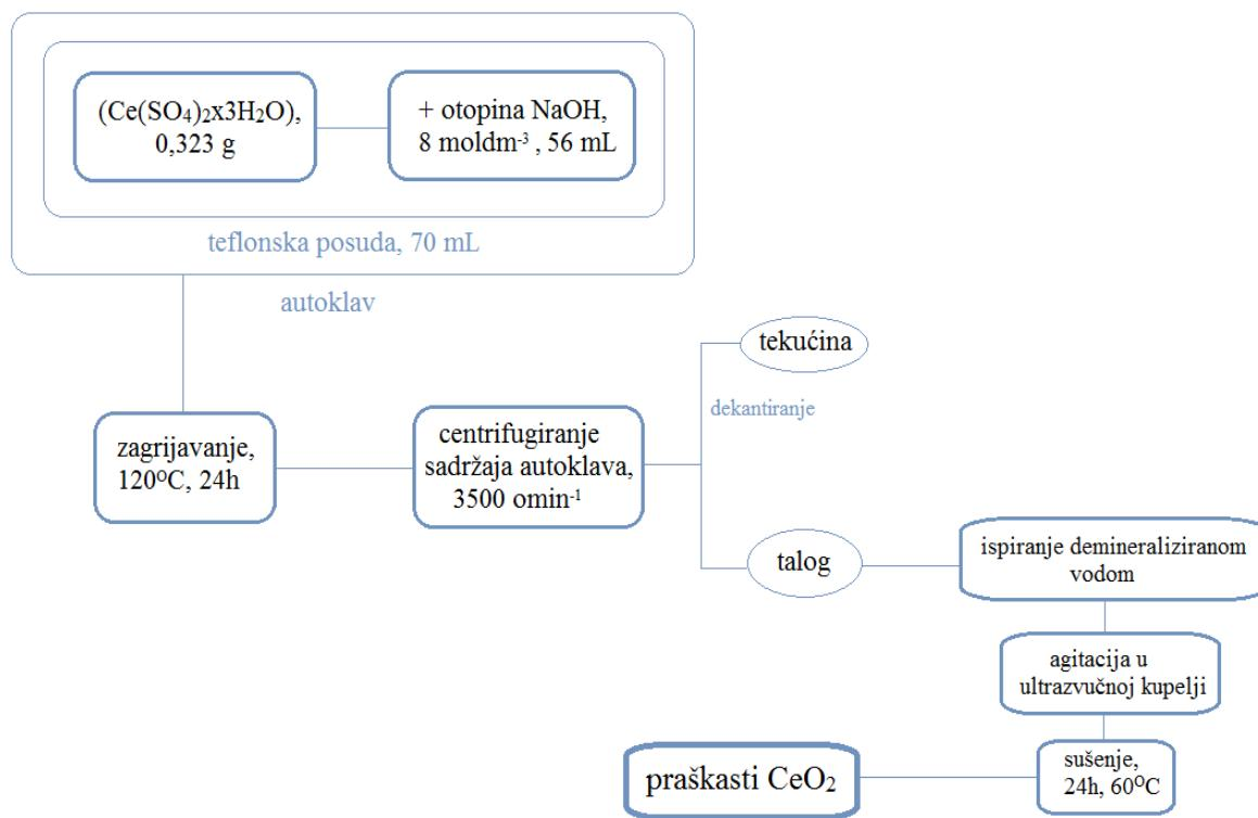
**Slika 3.3.** Shematski prikaz priprave praškastog CeO<sub>2</sub> katalizatora primjenom hidrotermičke sinteze
