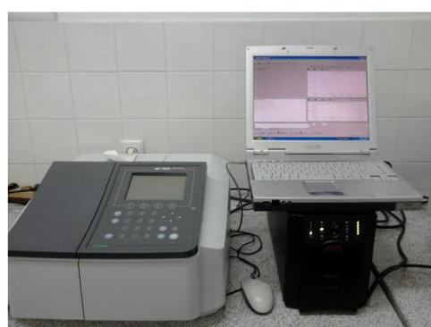
Slika 2. Spektrofotometar, Shimadzu - UV 1800
