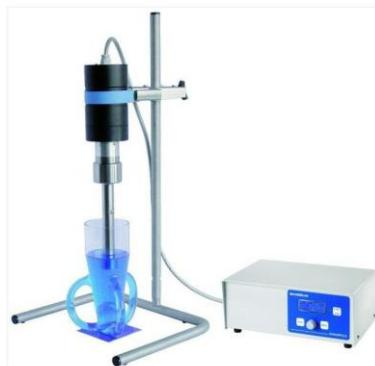
Slika 1. Ultrazvučna sonda Sonoplus HD 34000
