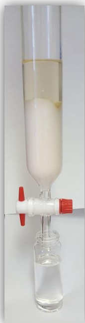
Slika 8. Uklanjanje inhibitora dodecil-metakrilata adsorpcijom u koloni
