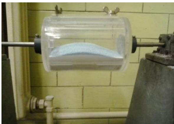
Slika 6. Cilindrična miješalica za praškaste materijale
