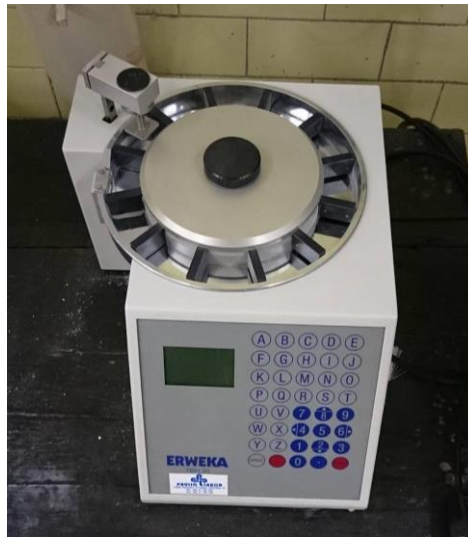
Slika 12. Uređaj za ispitivanje tvrdoće i dimenzija tablete
