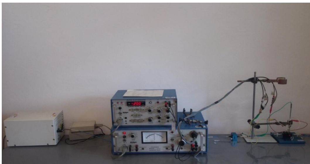
Slika 3.4. Aparatura za UV/VIS spektroskopiju sa potenciostatom
