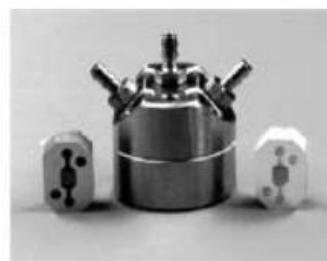
**Slika 10.** Mikromiješalo izrađen od nehrđajućeg čelika i drugih metala [7]
