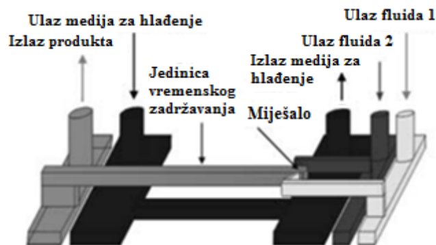
Slika 8. Izmjenjivač topline, miješalo i jedinica za zadržavanje u sklopu mikroreaktora [7]
