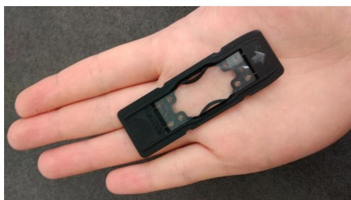
**Slika 6.** Primjer jednog mikroreaktora tvrtke Micronit – Microfluidics
