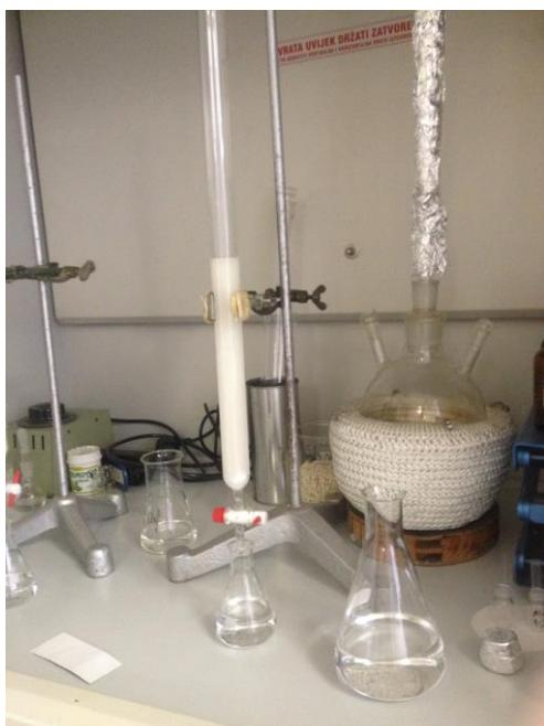
**Slika 1:** Aparatura za kolonsku kromatografiju
