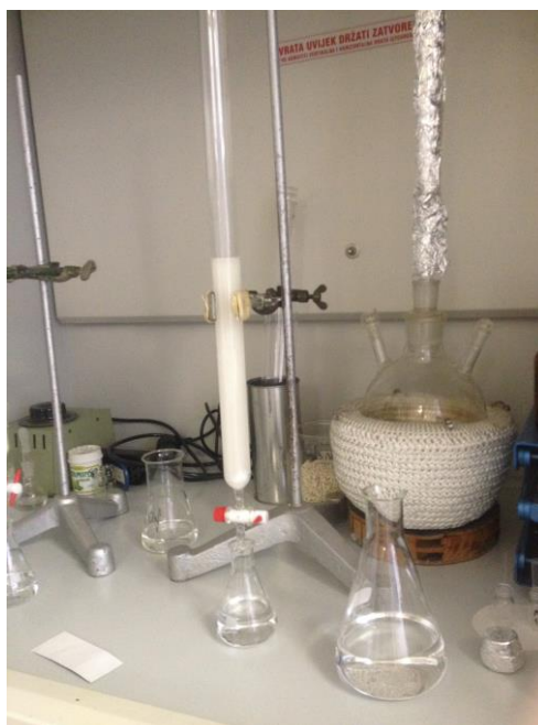
Slika 1: Aparatura za kolonsku kromatografiju
