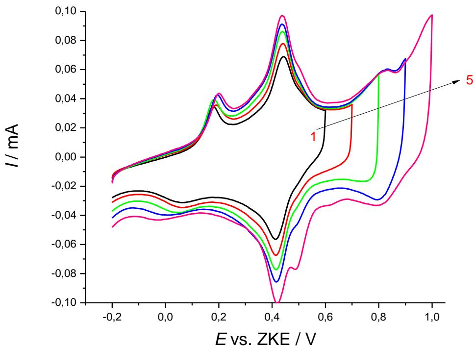
**Slika 4.1.1.** Ciklički voltamogram Au/GO elektrode s nanesenim anilinom iz 1 M H<sub>2</sub>SO<sub>4</sub> kroz pet suksesivnih ciklusa promjene potencijala i kod različitih konačnih potencijala. Brzina promjene potencijala:  $v=50 \text{ mV/s.}$
