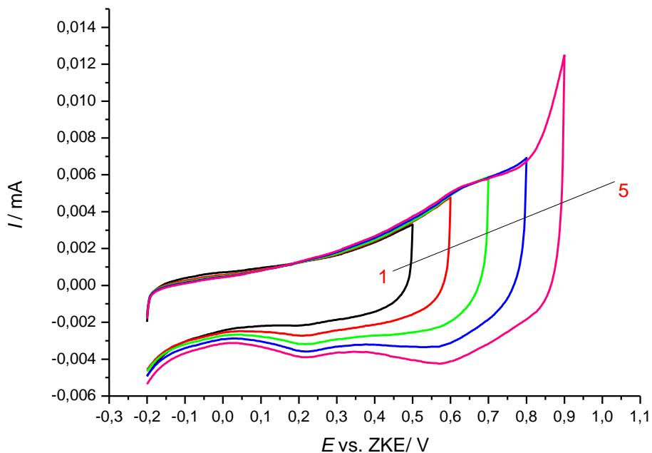
**Slika 4.1.** Ciklički voltamogram Au/GO elektroda bez nanijetog anilina kroz pet sukcesivnih ciklusa promjene potencijala i kod različitih konačnih potencijala. Brzina promjene potencijala:  $v=50 \text{ mV/s}$
