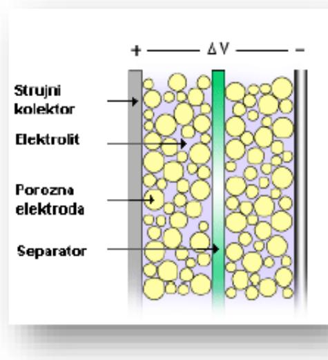
**Slika 2.4.2** Pojednostavljena shema superkondenzatora
