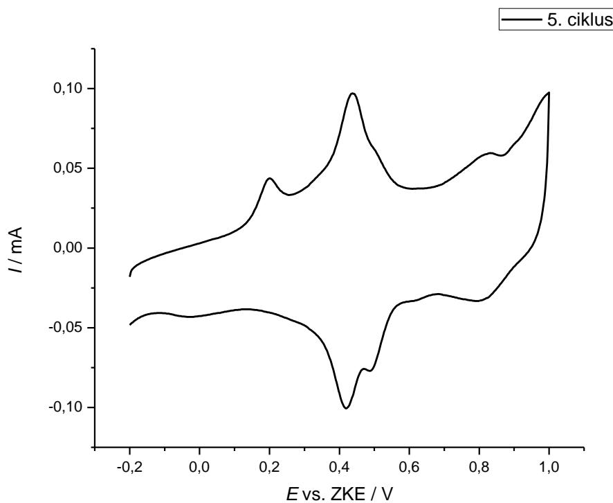
**Slika 5.2.** Ciklički voltamogram Au/GO elektrode s anilinom nanesenim iz 1 M  $\text{H}_2\text{SO}_4$
