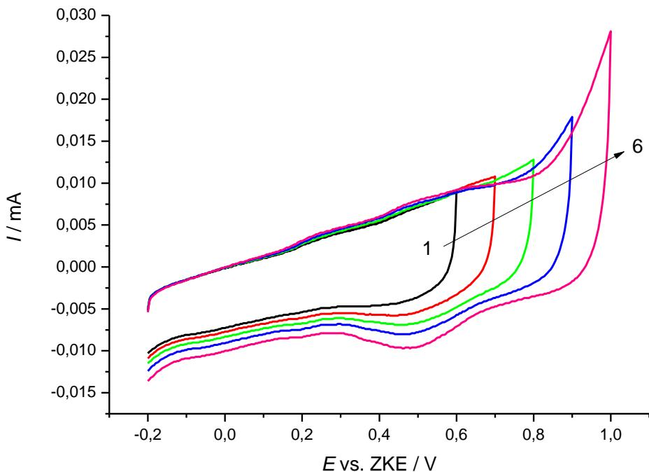
**Slika 4.2.1.** Ciklički voltamogram Au/GO elektrode s nanesenim anilinom iz 1 M NaOH kroz pet sukcesivnih ciklusa promjene potencijala i kod različitih konačnih potencijala. Brzina promjene potencijala:  $v=50$  mV/s.
