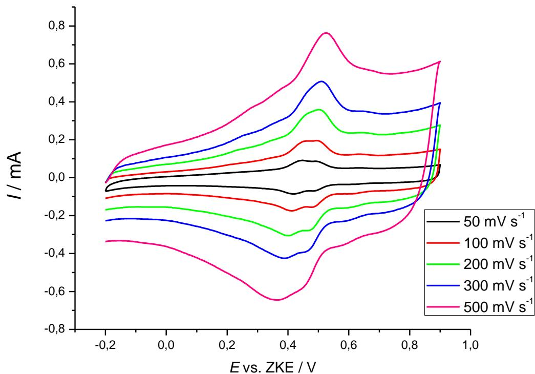
**Slika 4.1.3.** Ciklički voltamogrami Au/GO elektrode s nanesenim anilinom iz  $1 \text{ M H}_2\text{SO}_4$  kod raznih brzina promjene potencijala,  $v=50 - 500 \text{ mV/s}$
