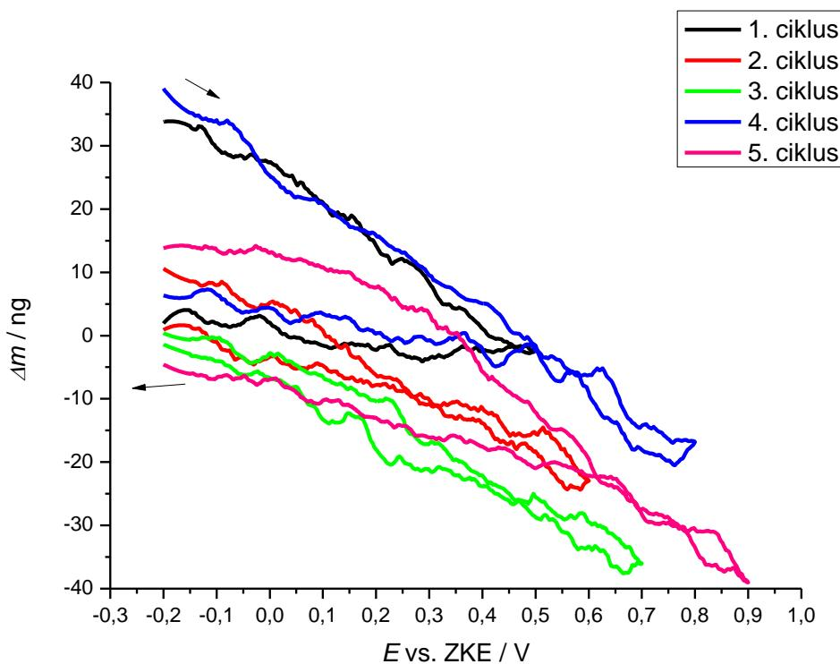
**Slika 4.2.** Promjena mase „čiste“ Au/GO elektrode kroz pet sukcesivnih ciklusa promjene potencijala. Brzina promjene potencijala:  $v=50 \text{ mV/s}$ .
