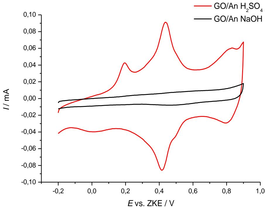
**Slika 5.6.** Usporedba cikličkih voltamograma Au/GO elektrode s anilinom nanesenim iz 1 M  $H_2SO_4$  i Au/GO elektrode s anilinom nanesenim iz 1 M NaOH
