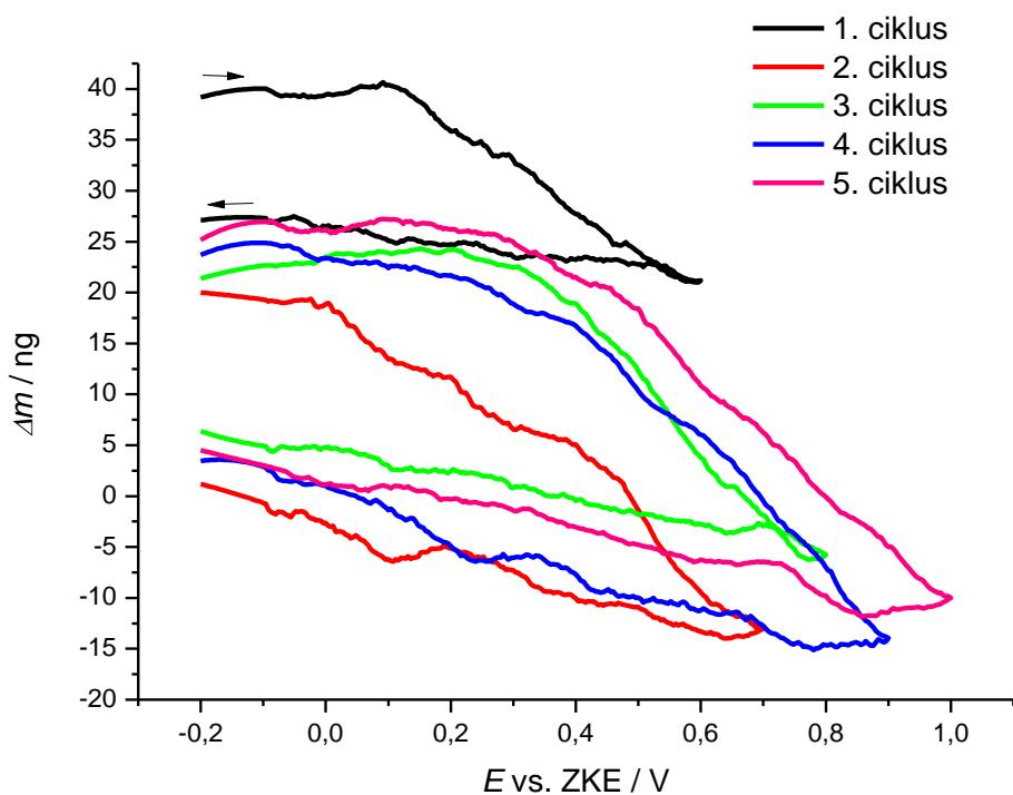
**Slika 4.2.2.** Promjena mase Au/GO elektrode s nanesenim anilinom iz 1 M NaOH kroz pet suksesivnih ciklusa promjene potencijala. Brzina promjene potencijala:  $v=50$  mV/s.
