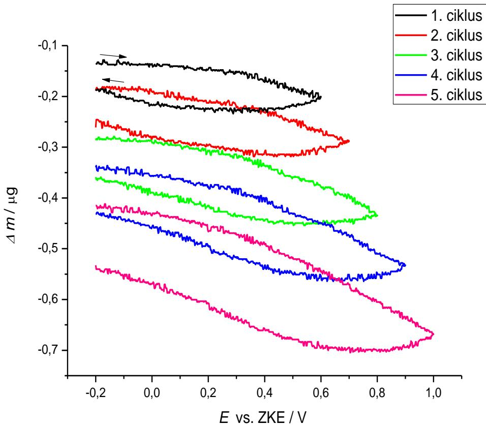
**Slika 4.1.2.** Promjena mase Au/GO elektrode s nanesenim anilinom iz 1 M H<sub>2</sub>SO<sub>4</sub> kroz pet suksesivnih ciklusa promjene potencijala. Brzina promjene potencijala:  $v=50$  mV/s.
