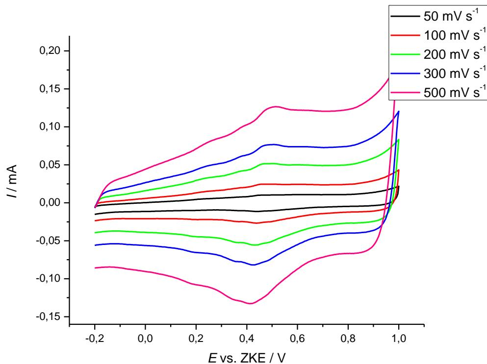
**Slika 4.2.3.**Ciklički voltamogrami Au/GO elektrode s nanesenim anilinom iz 1 M NaOH kod raznih brzina promjene potencijala,  $v=50-500$  mV/s.
