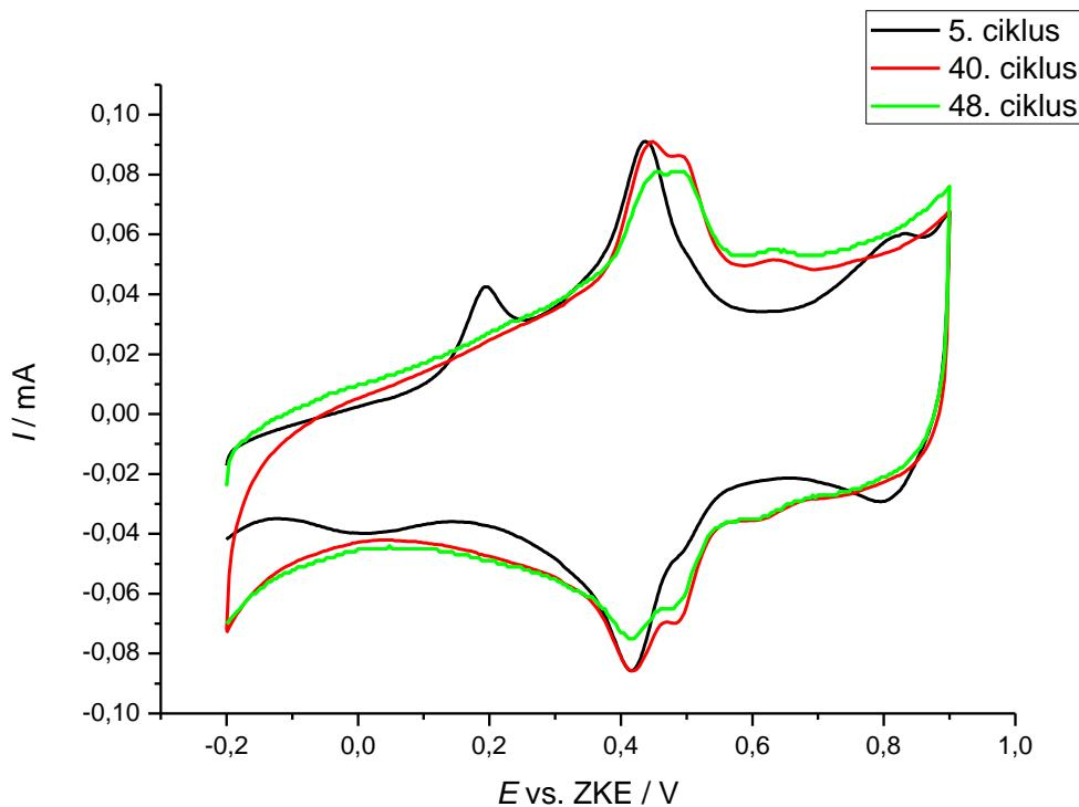
**Slika 4.1.4.** Usporedba cikličkih voltamograma petog, četrdesetog i četrdeset osmog ciklusa ispitivanja Au/GO elektrode s nanesenim anilinom iz 1 M  $\text{H}_2\text{SO}_4$ . Brzina promjene potencijala:  $v=50 \text{ mV/s.}$
