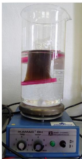
Slika 3.1. Dijaliza otopine grafenova oksida
