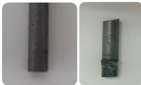
Slika 5.3. Grafitni štapić prije i nakon raslojavanja
