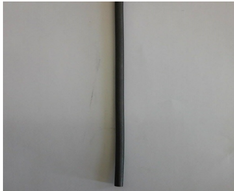
Slika 3.1. Radne elektrode: a) prirodni grafit nanesen na podlogu od Pt i b) grafitni štapić od prirodnog grafita.
