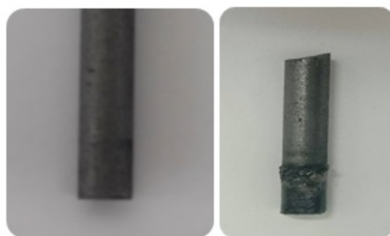
Slika 5.3. Grafitni štapić prije i nakon raslojavanja
