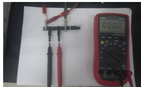
Slika 31. a) Instrument za puštanje struje određene jakosti; b) Električni krug na uzorku prema metodi četiri kontakta s voltmetrom
