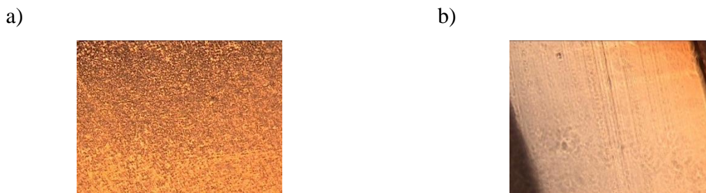
Slika 32. Optička polarizacija čistog polimera pri uvećanju 20x a) PE-HD i b) PE-LD
