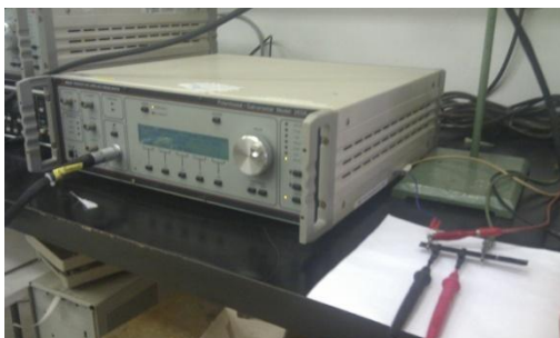
Slika 31. a) Instrument za puštanje struje određene jakosti; b) Električni krug na uzorku prema metodi četiri kontakta s voltmetrom
