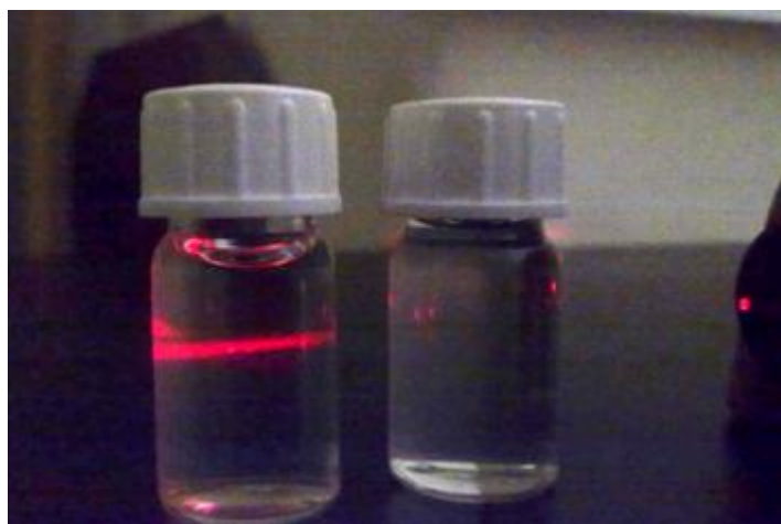
Slika 31. Prikaz probe na Tyndallovog efekt, na česticama otopine spoja 1 (lijevo), i deionizirane vode (desno).
