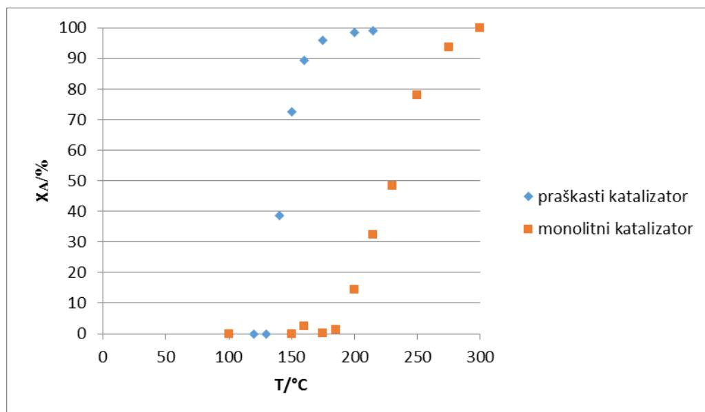
**Slika 5.4.** Usporedba rezultata dobivenih u cijevnom reaktoru s nepokretnim slojem katalizatora i monolitnom reaktoru pri različitim temperaturama uz konstantnu početnu koncentraciju toluena i  $v_{uk}=92$  mL/min (korišteni su podaci iz tablica 4.1. i 4.3.)
