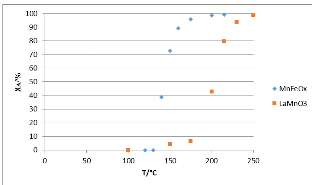
**Slika 5.1.** Usporedba rezultata dobivenih u cijevnom reaktoru s nepokretnim slojem MnFeO<sub>x</sub> i LaMnO<sub>3</sub> katalizatora pri različitim temperaturama uz konstantnu početnu koncentraciju toluena te uz  $v_{uk}=92$  mL/min (korišteni su podaci iz tablica 4.1. i 4.2.)
