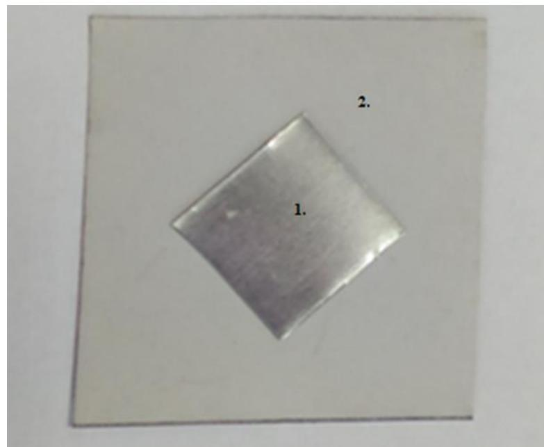
**Slika 3.2.1- Metalna pločica Al/Al<sub>2</sub>O<sub>3</sub>, 2- Anodizirana metalna pločica Al/Al<sub>2</sub>O<sub>3</sub>**
