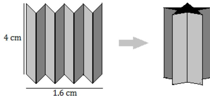
**Slika 3.3. Shematski prikaz priprave metalne monolitne strukture**
