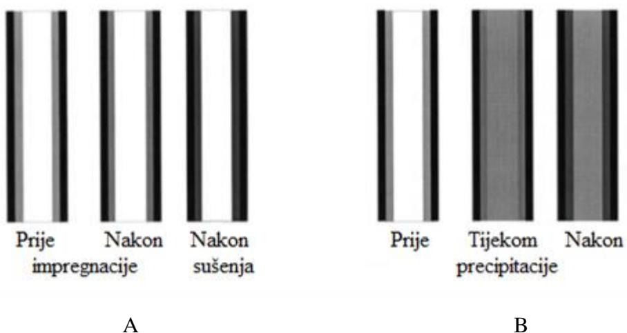
**Slika 2.8.** Nanošenje sekundarnog nosača na stijenke monolita primjenom različitih metoda
