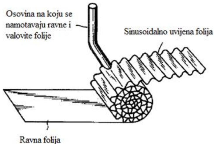
**Slika 2.4.** Monolitna izvedba dobivena nabiranjem (savijanjem) naizmjeničnih ravnih i valovitih traka oko osovine valjka<sup>7</sup>
