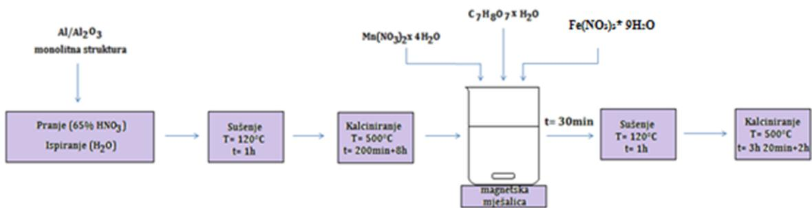
**Slika 3.1.** Shematski prikaz postupka pripreme metalnog monolitnog katalizatora
