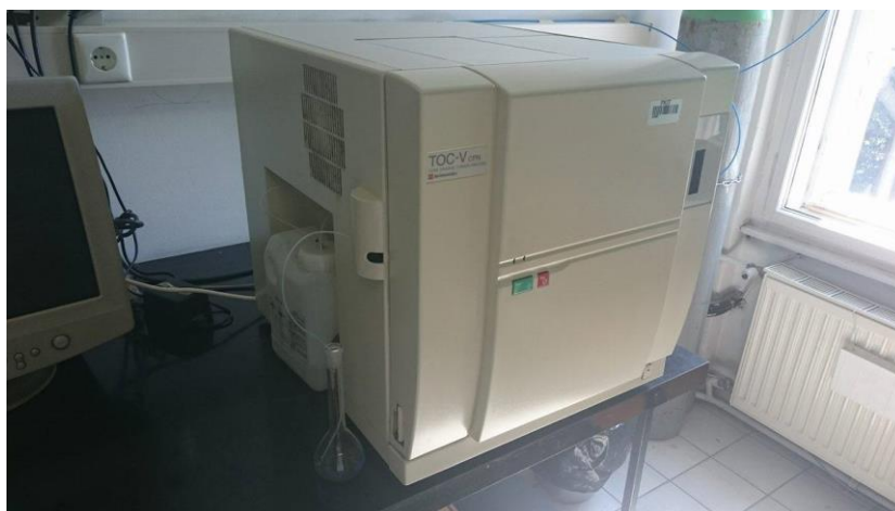
Slika 7. TOC analizator, TOC - V CPN , Shimadzu
