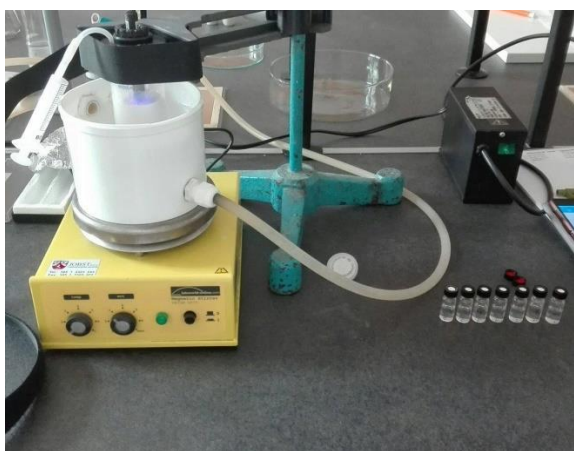
Slika 8. Reaktor s protočnom vodenom kupelji
