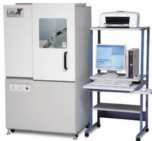
Slika 3.7. Rendgenski difraktometar Shimadzu XRD-600
