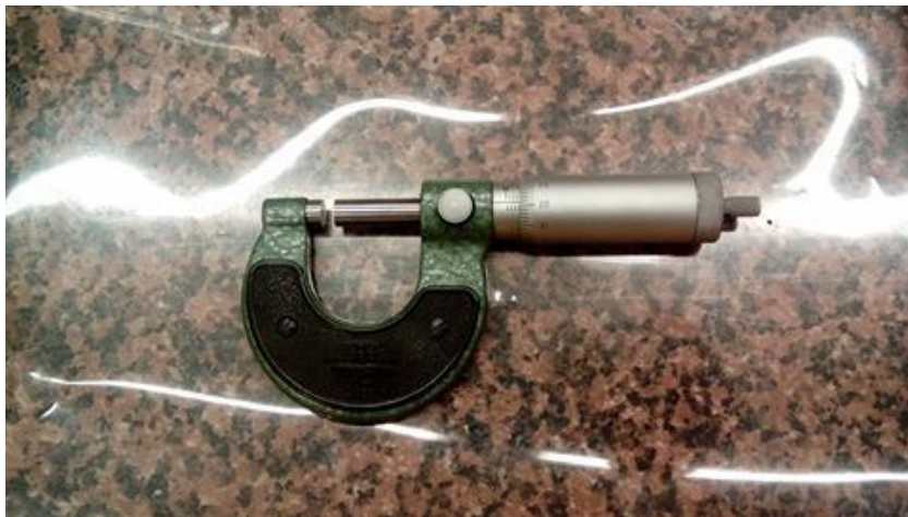
Slika 3.9. Uređaj za određivanje debljine listova
