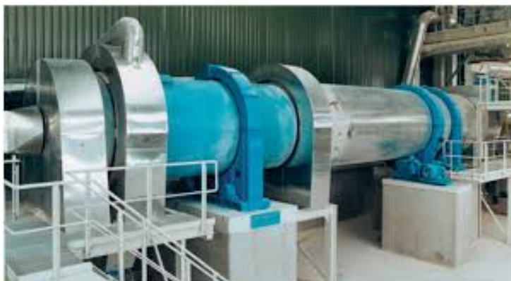
Slika 7. Rotacijski kalcinator gipsa [2]
