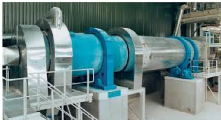
**Slika 7.** Rotacijski kalcinator gipsa<sup>[2]</sup>
