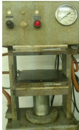
Slika 11. Hidraulička preša Dake Model 44-226
