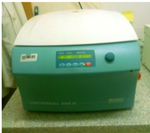
Slika 11. Centrifuga Hettich Universal 320R
