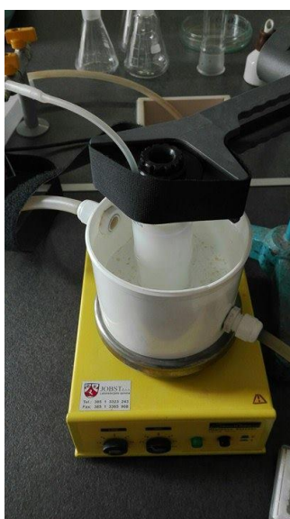
Slika 6. Reaktor s protočnom vodenom kupelji
