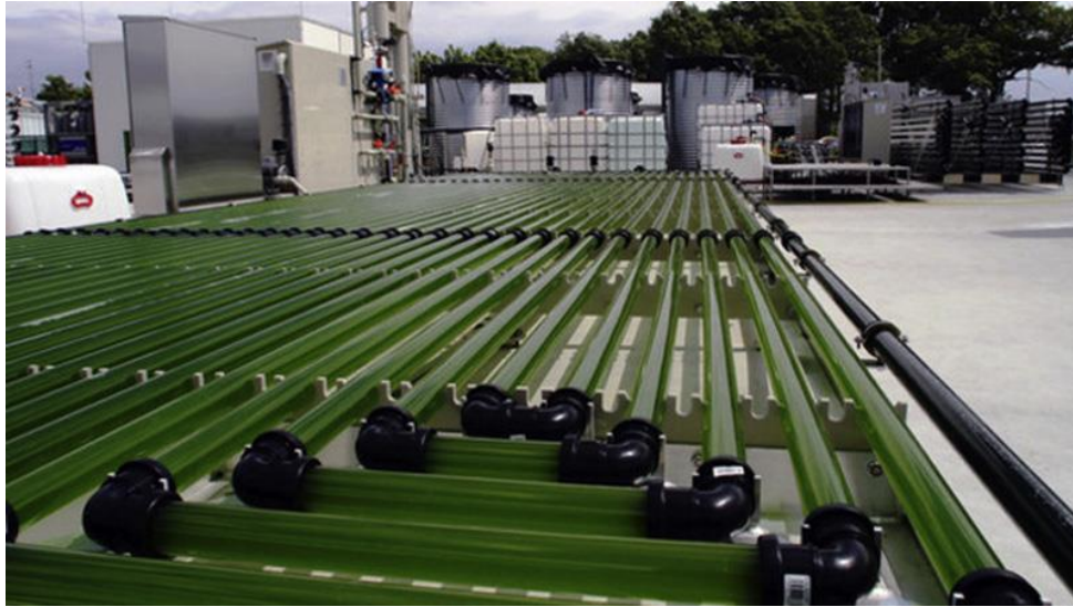
Slika 3.3. Zatvoreni sustav za uzgoj mikroalgi u cijevnim fotobioreaktorima 14
