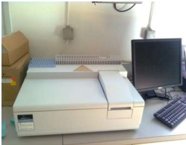
Slika 3. 1. UV/VIS spektrofotometar Lambda 35 (PerkinElmer, Waltham, SAD)
