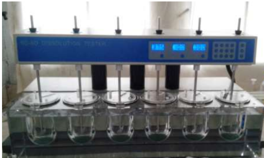
Slika 3. 3. Uređaj za ispitivanje brzine otpuštanja djelatne tvari RC-6D, Zhengzhou Nanbei Instrument
