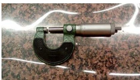
Slika3.7. Mikrometar za određivanje debljine listova
