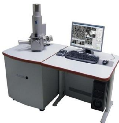
Slika3.5. Pretražni elektronski mikroskop Tescan Vega 3
