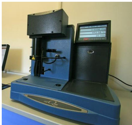
Slika 3.3. Termogravimetar Q500 TA Instruments
