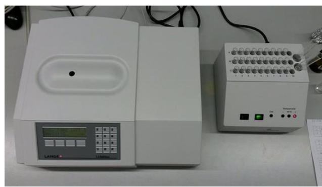
Slika 18. Uređaj za provedbu toksičnosti (LUMISTox 300)
