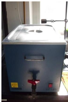
Slika 15. Ultrazvučna kupelj
