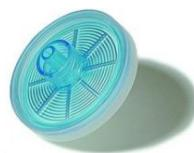
**Slika 20.** Filter za injekcije ( $0,22 \mu\text{m}$ )
