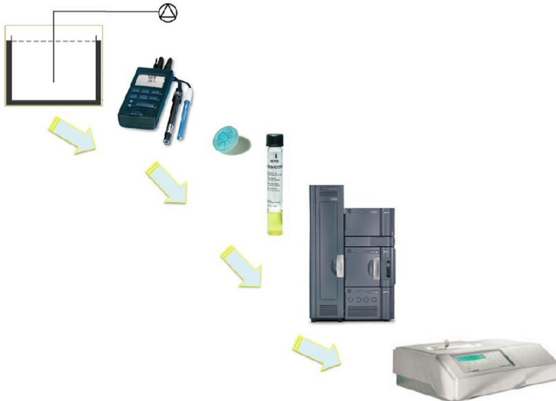
**Slika 9.** Dijagram toka eksperimentalnog dijela rada: shema reaktora za biorazgradnju, pH-metar, filter za injekcije ( $0,22 \mu\text{m}$ ), kiveta s reagensima za analizu KPK, UPLC, luminometar
