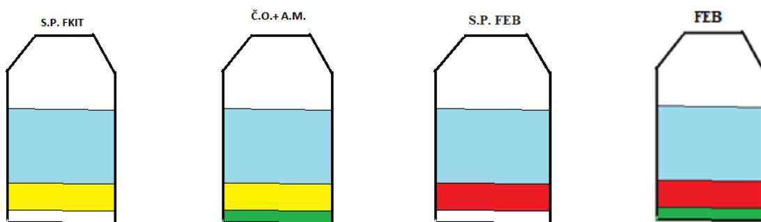
**Slika 22.** Sheme reaktora potrebnih za izvedbu eksperimenata biorazgradnje farmaceutika febantela (legenda: crvena- TSO farmaceutika, zelena- aktivni mulj, žuta- čisto otapalo, plava- vodovodna voda)
