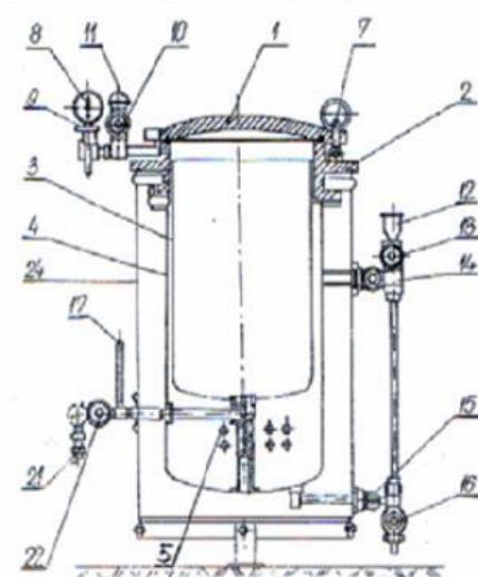
Slika 1. Autoklav: 1-poklopac, 2-prsten, 3-unutrašnja stjenka, 4-vanjska stjenka, 5-električni grijač, 7-metalni zavrtanj, 8-manometar, 9-sigurnosni ventil, 10-ventilacijski ventil, 11-ventilacijska šalica, 12-ljevak za punjenje, 13-, 14-, 15- i 16-ventili sustava za punjenje, 17-termometar, 21-odvod, 22-ventil za ispuštanje, 24-plašt autoklava
