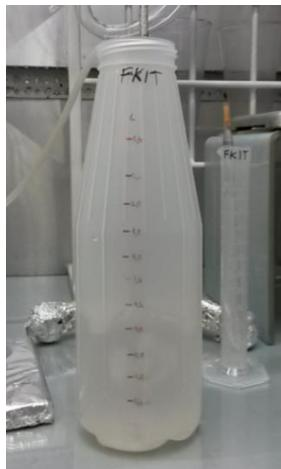
**Slika 19.** Reaktor u kojem se vodio proces biorazgradnje
