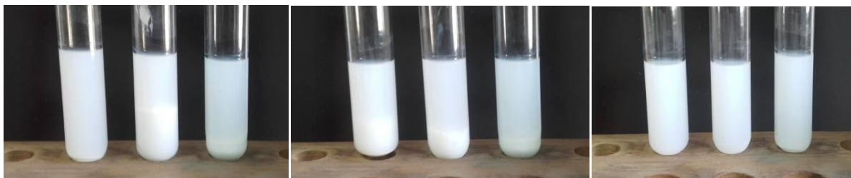
Slika 32. Slijeva na desno, uzorci 1-9, čiji je sastav dan tablicom 1, namijenjeni nanošenju sloja uranjanjem
