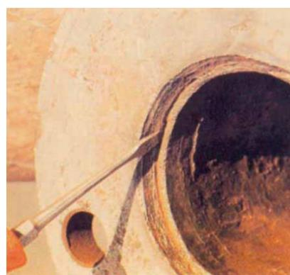
*Slika 9. Korozija u cijevi izazvana morskom vodom [41].*
