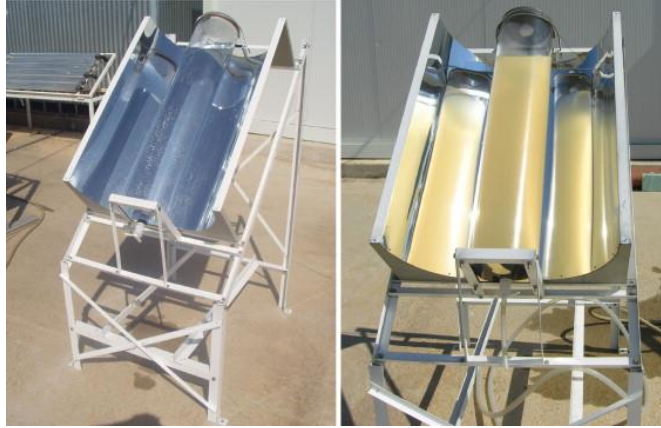
Slika 11. Postupak dezinfekcije vode UV zračenjem [54].
