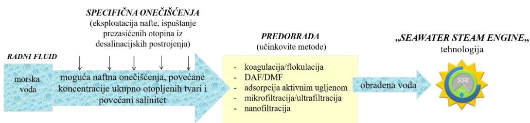
*Slika 34. Specifična onečišćenja za lokaciju Dubai (UAE) i postupci predobrade onečišćene vode.*
