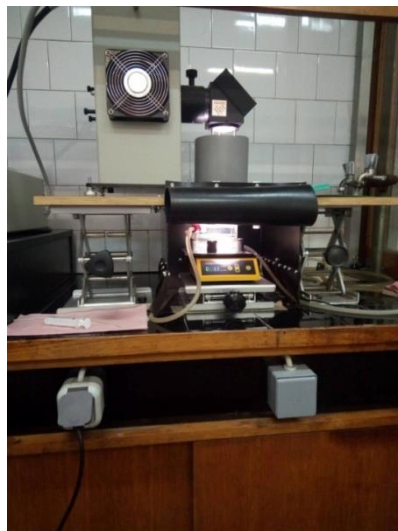
Slika 13. Proces uklanjanja diklofenaka iz vode pod simuliranim Sunčevim zračenjem.
