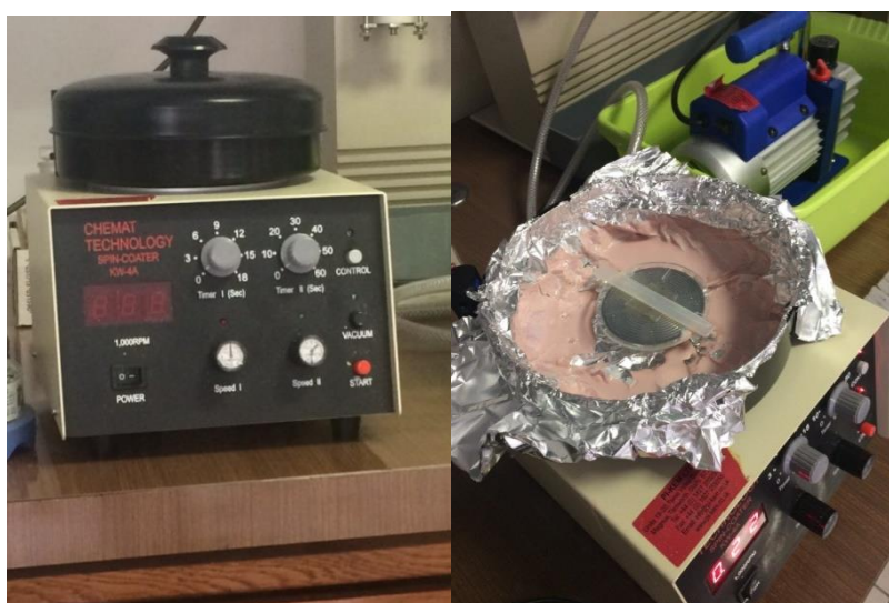
Slika 14. Nanošenje fotokatalizatora na „Spin-coateru“
