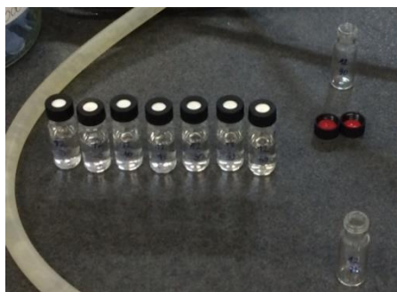
Slika 19. Viala s uzorcima izuzetim tijekom obrade otopine DCF-a UV-A/TiO 2 /Fe-ZSM5 procesom
