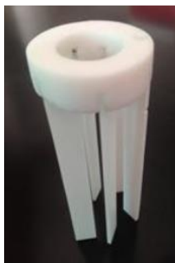
Slika 18. Teflonski nosač s 6 staklenih pločica
