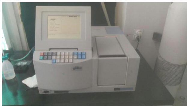
Slika 11. UV/VIS spektrofotometar, Lambda EZ 201, Perkin Elmer
