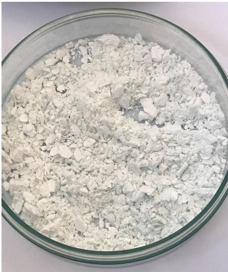
Slika 4.1. DAS N-oxid dobiven oksidacijom DAS-a vodikovim peroksidom
