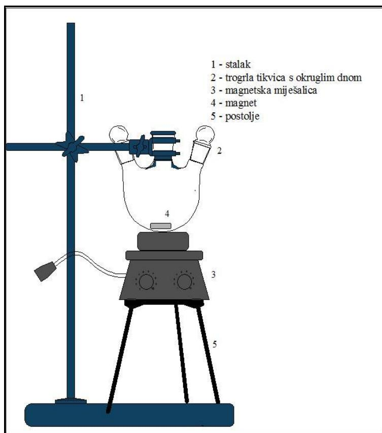
*Slika 3.3.* Aparatura za oksidaciju DAS-a vodikovim peroksidom ( $H_2O_2$ ) u N-metil pirolidonu ( $C_5H_9NO$ )
