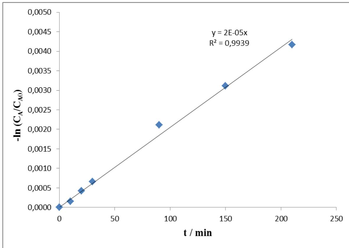
*Slika 5.1.* Testiranje eksperimentalnih rezultata na prepostavljeni model za reakciju prvog reda u kotlastom reaktoru primjenom integralne metode kinetičke analize (za pokus XXI)
