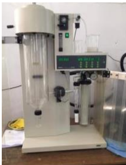
Slika 20. Sušionik s raspršivanjem Mini SprayDryer B-290
