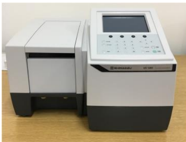
Slika 22. UV/ Vis spektrofotometar Shimadzu, UV-1280
