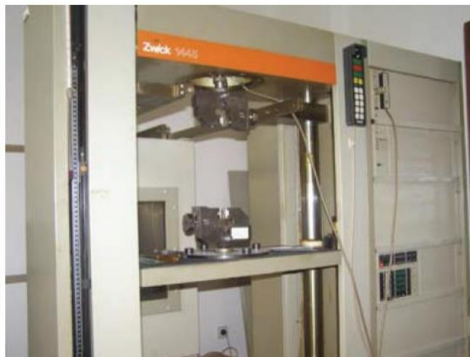
Slika 17. Univerzalna mehanička kidalica ZWICK 1445.
