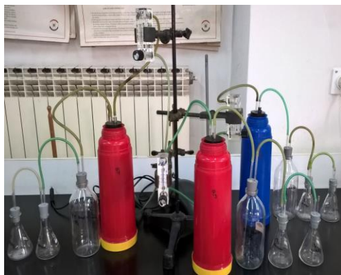
Slika 17. Aparatura za kompostiranje.
