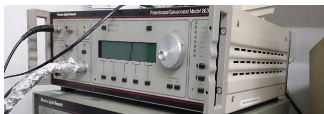
Slika 1. Potencijostat EG&G Princeton Applied Research, model 263A
