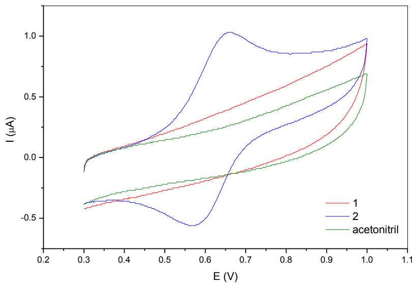
Slika 18. Ciklički voltamogram spojeva **1** i **2** u  $0,1 \text{ mol dm}^{-3}$   $\text{LiBF}_4$  u acetonitrilu
