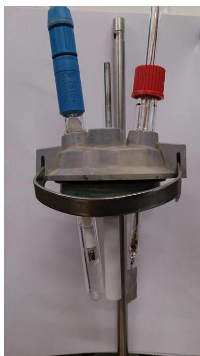
Slika 2. Troelektrodni sustav
