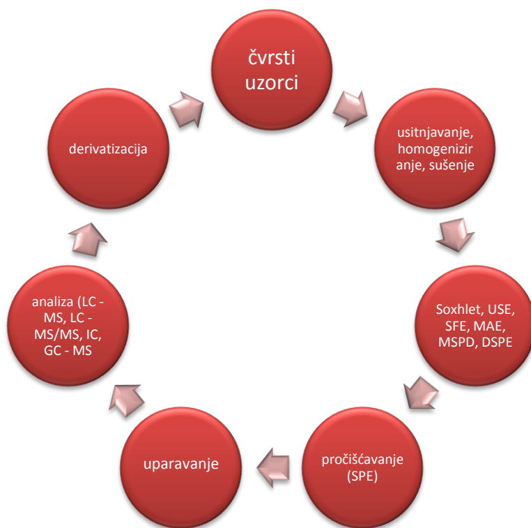
Slika 14. Prikaz mogućih postupaka pripreme uzorka s obzirom na agregacijsko stanje 49
