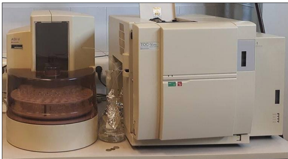
Slika 3.11. TOC analizator, Shimadzu TOC-V CPH/CPN + ASI-V autosampler.
