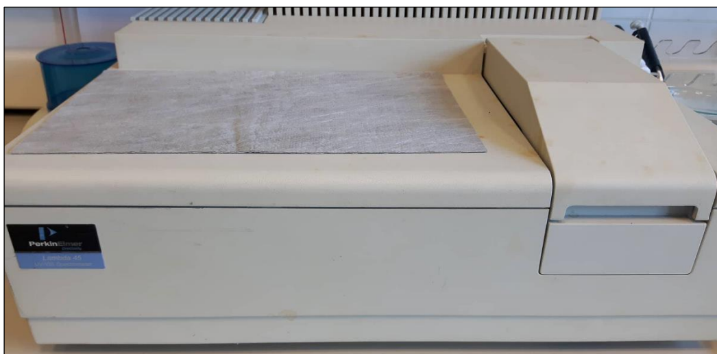
Slika 3.13. UV/Vis spektrometar, Perkin Elmer Lambda 45.
