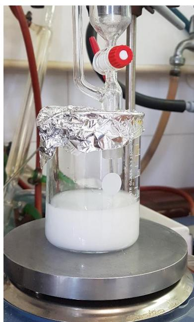
**Slika 11.** Priprema predemulzije uz dokapavanje monomera kroz lijevak
