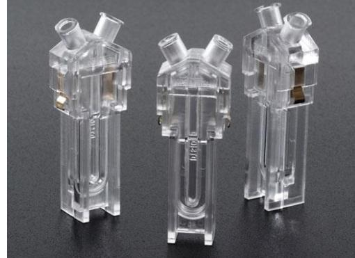
**Slika 15.** Jednokratne kapilarne čelije za mjerjenje zeta-potencijala DTS1061
