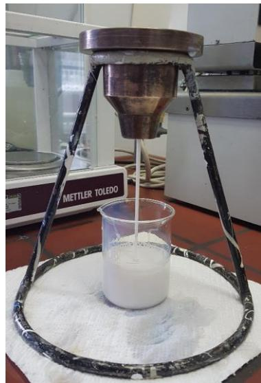
**Slika 17.** Fordov viskozimetar
