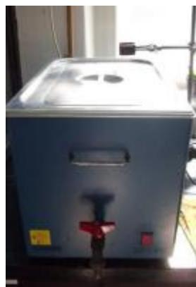
Slika 9. Ultrazvučna kupelj
