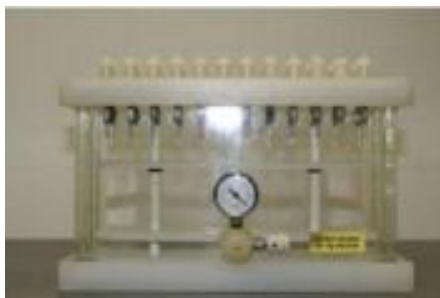
Slika 10. Aparatura za ekstrakciju uzorka kroz čvrstu fazu
