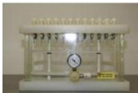
Slika 10. Aparatura za ekstrakciju uzorka kroz čvrstu fazu
