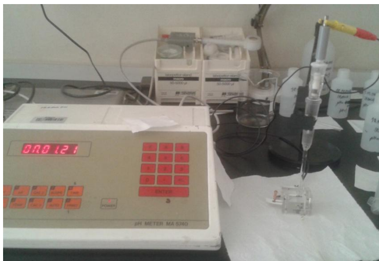
Slika 22. Prikaz aparature za izvedbu neprotočnog mjerenja pH.
