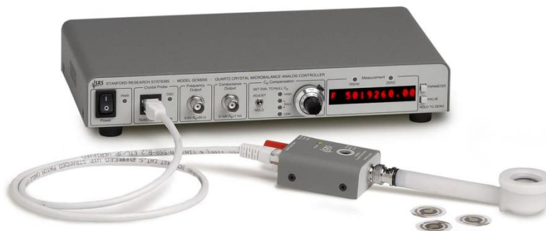
Slika 2.22. EQCM i pripadajuće kvarc-kristalne zlatom prevučene elektrode.
