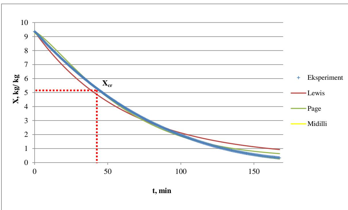
**Slika 51.** Grafički prikaz promjene sadržaja vlage uzorka paprike s vremenom pri 60 °C te primjenjivost Lewis-ovog, Page-ovog i Midilli-Kucuk-ovog modela
