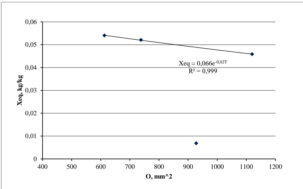
**Slika 35.** Grafički prikaz ovisnosti ravnotežnog sadržaja vlage  $X_{eq}$  o oplošju uzorka celera  $O$
