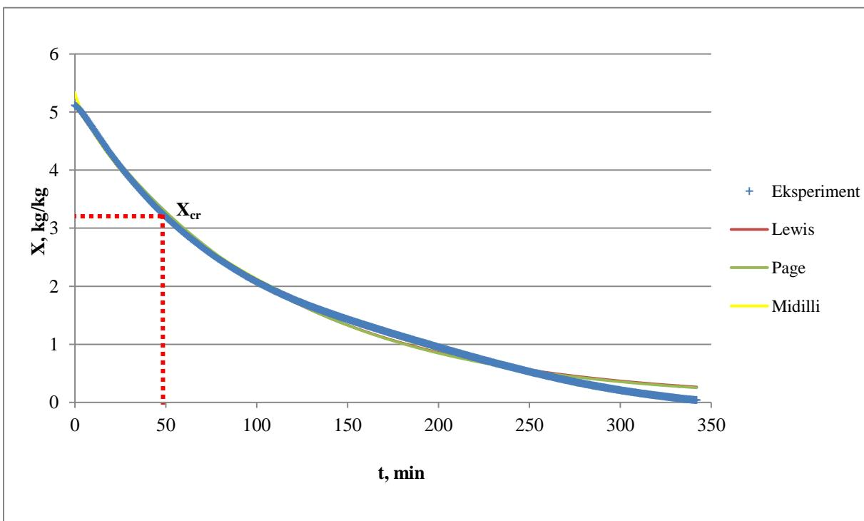
**Slika 62.** Grafički prikaz promjene sadržaja vlage uzorka korijena peršina s vremenom pri  $70\text{ }^{\circ}\text{C}$  te primjenjivost *Lewis*-ovog, *Page*-ovog i *Midilli-Kucuk*-ovog modela
