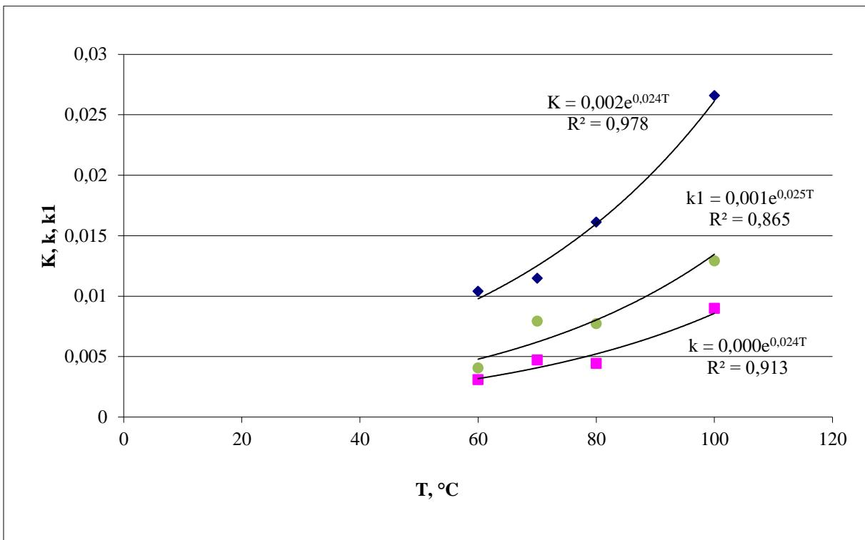
**Slika 44.** Grafički prikaz ovisnosti parametara *Lewis*-ovog ( $K$ ), *Page*-ovog ( $k$ ) i *Midilli-Kucuk*-ovog ( $k_1$ ) modela o temperaturi  $T$  za uzorke mrkve
