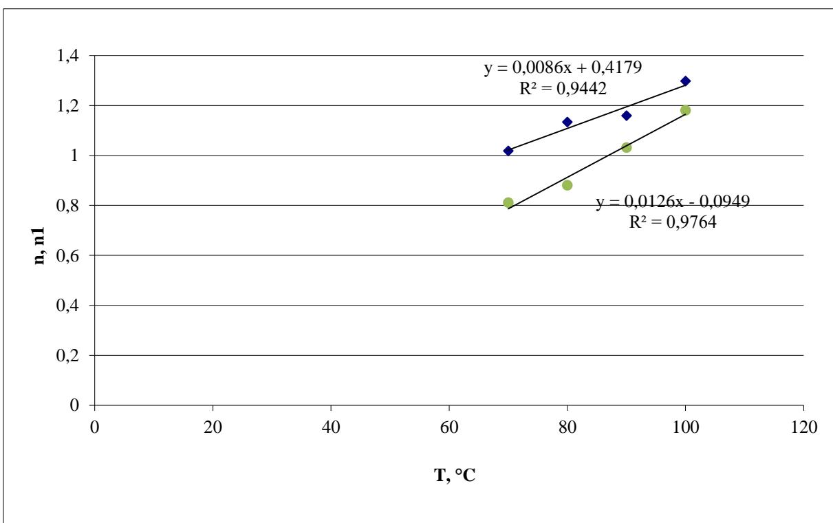
**Slika 67.** Grafički prikaz ovisnosti parametra *Page*-ovog modela  $n$  i *Midilli-Kucuk*-ovog  $n1$  o temperaturi sušenja  $T$  za uzorke korijena peršina
