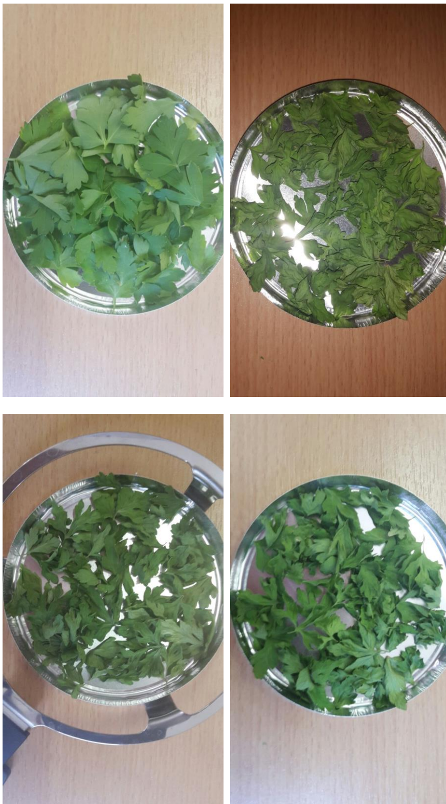
Slika 69. Uzorci lišća peršina prije i nakon sušenja u infracrvenom sušioniku pri 40 °C, 80 °C i 100 °C
