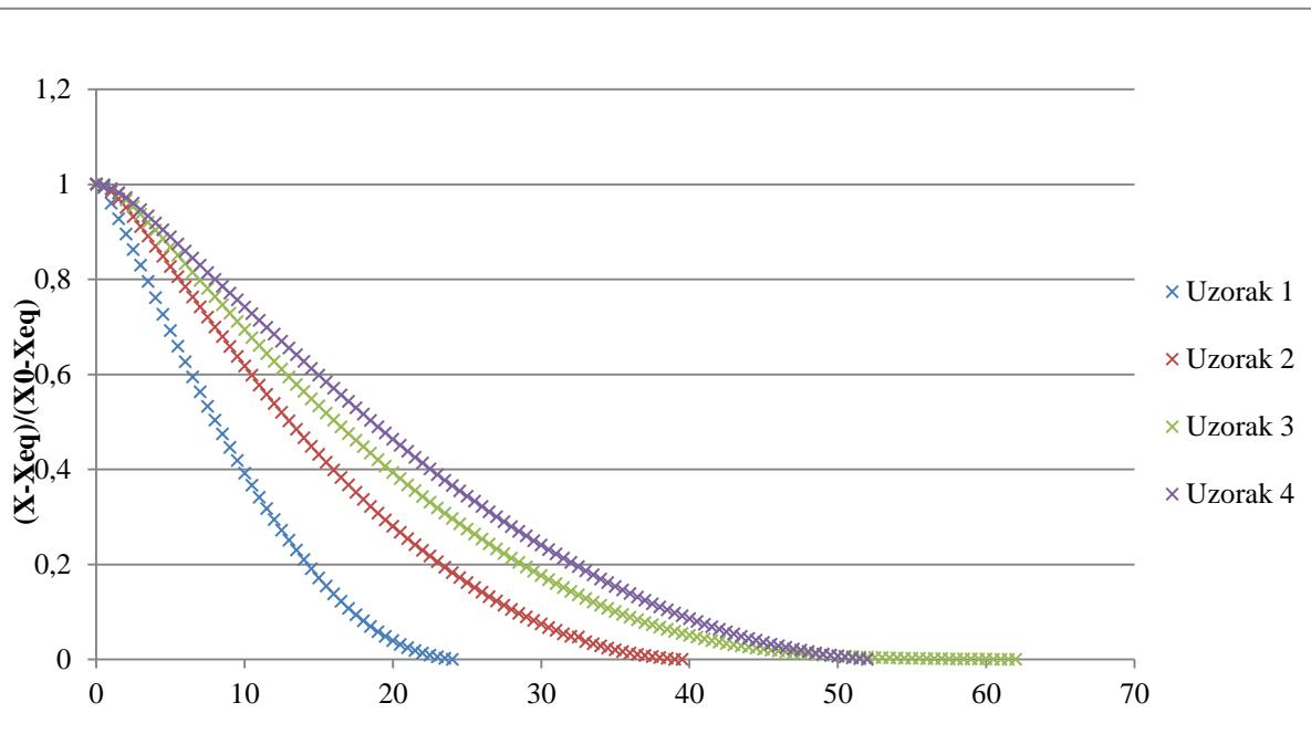
**Slika 27.** Grafički prikaz promjene sadržaja vlage s vremenom za uzorke celera različite vrijednosti oplošja  $O$  pri temperaturi  $T = 100$  °C
