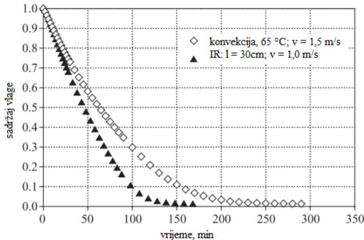
**Slika 9.** Usporedba vremena sušenja infracrvenog i konvekcijskog sušionika<sup>14</sup>
