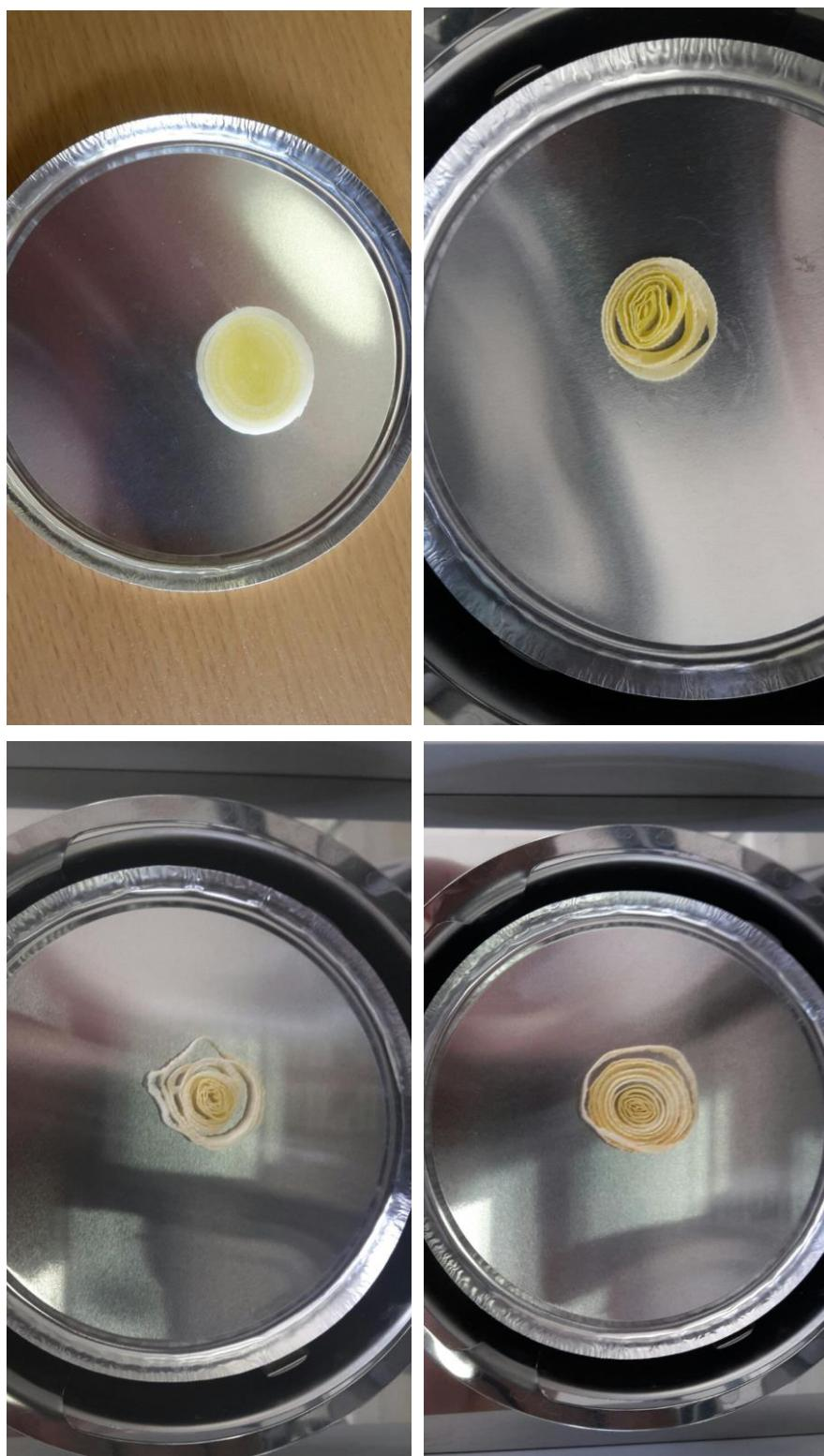
**Slika 80.** Uzorci poriluka prije i nakon sušenja u infracrvenom sušioniku pri  $60\text{ }^{\circ}\text{C}$ ,  $80\text{ }^{\circ}\text{C}$  i  $100\text{ }^{\circ}\text{C}$
