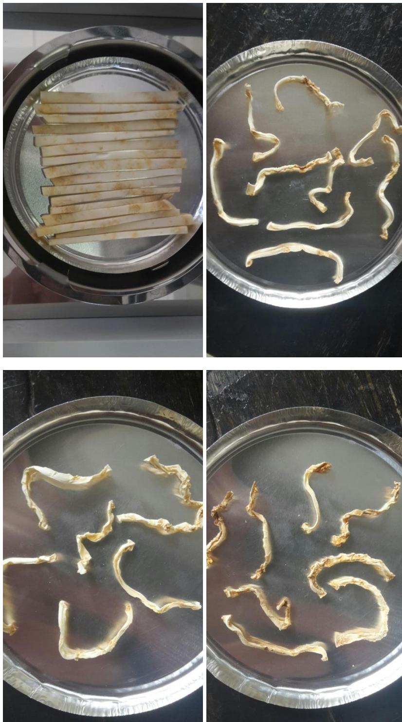
Slika 16. Uzorci celera prije i nakon sušenja u infracrvenom sušioniku pri 60 °C, 80 °C i 100 °C
