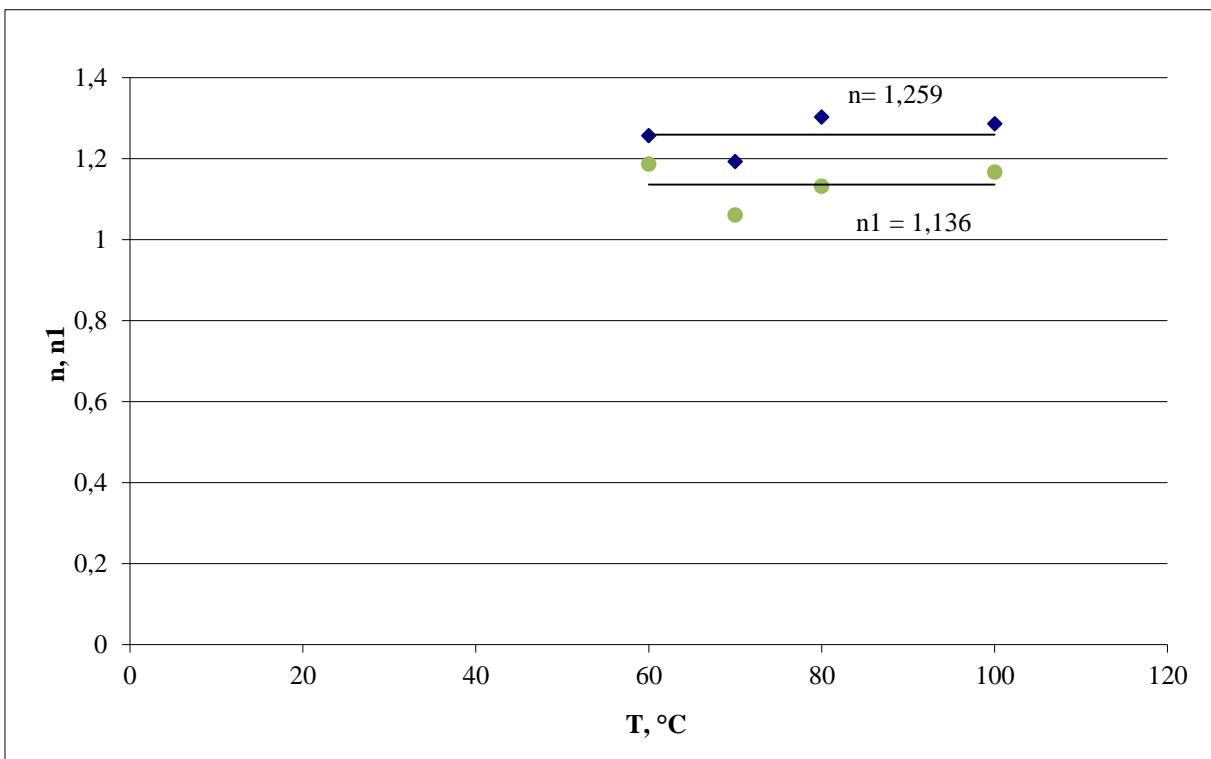
**Slika 45.** Grafički prikaz ovisnosti parametra *Page*-ovog modela  $n$  i *Midilli-Kucuk*-ovog  $n_1$  o temperaturi sušenja  $T$  za uzorke mrkve
