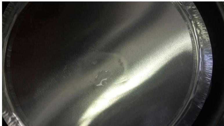
**Slika 91.** Zaostala voda nakon sušenja uzorka korijena peršina na temperaturi  $T= 60$  °C
