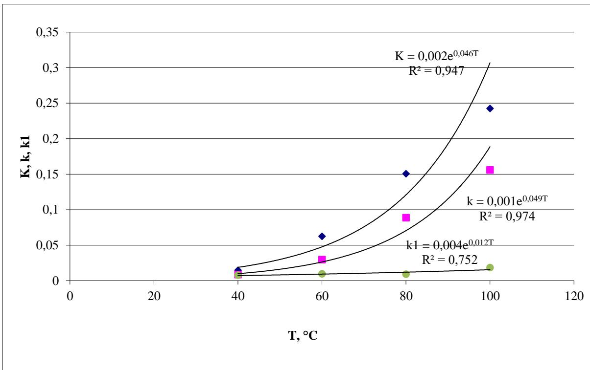
**Slika 77.** Grafički prikaz ovisnosti parametara *Lewis*-ovog ( $K$ ), *Page*-ovog ( $k$ ) i *Midilli-Kucuk*-ovog ( $kI$ ) modela o temperaturi  $T$  za uzorke lišća peršina
