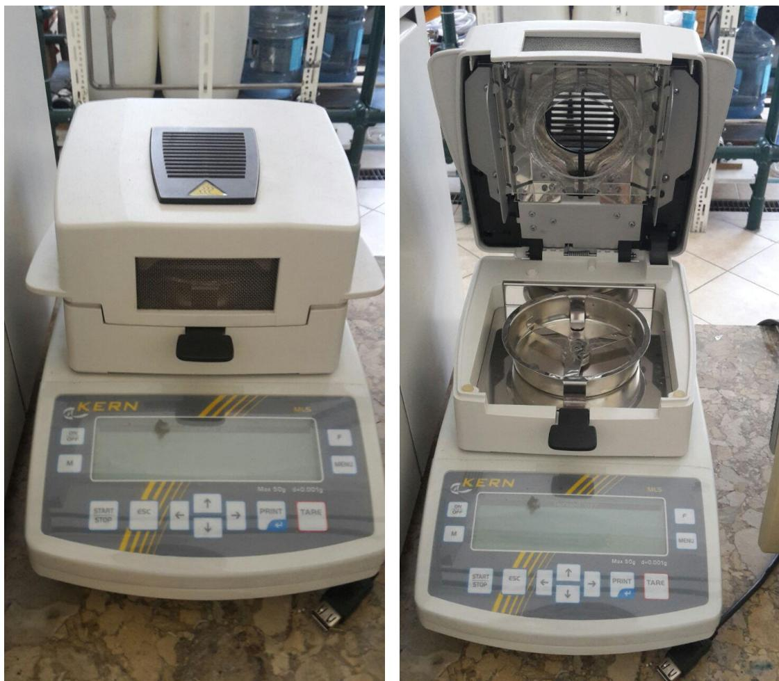
Slika 12. Infracrveni sušionik KERN Moisture analyser MLS-C
