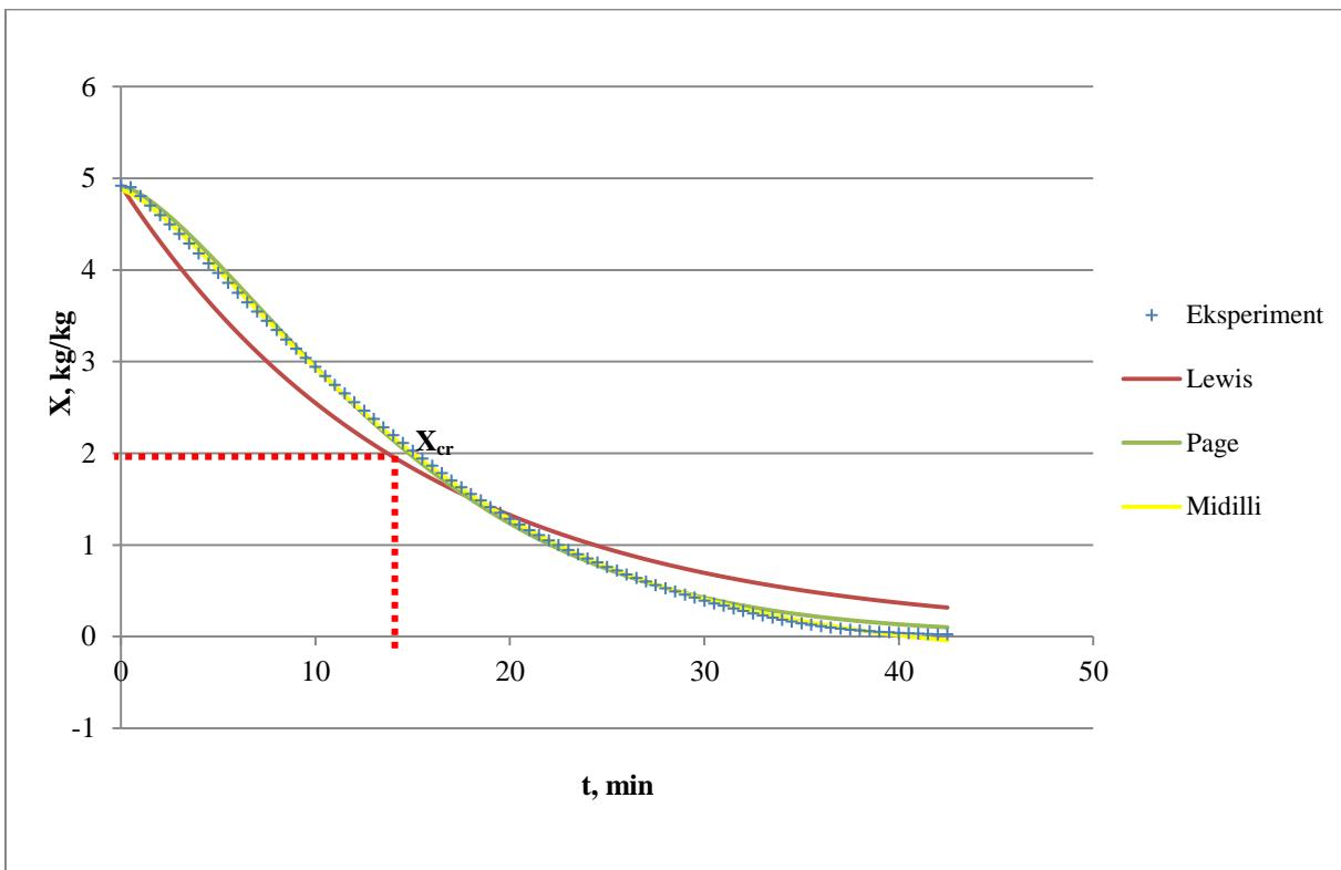
**Slika 87.** Grafički prikaz promjene sadržaja vlage uzorka poriluka s vremenom pri  $100\text{ }^{\circ}\text{C}$  te primjenjivost *Lewis*-ovog, *Page*-ovog i *Midilli-Kucuk*-ovog modela
