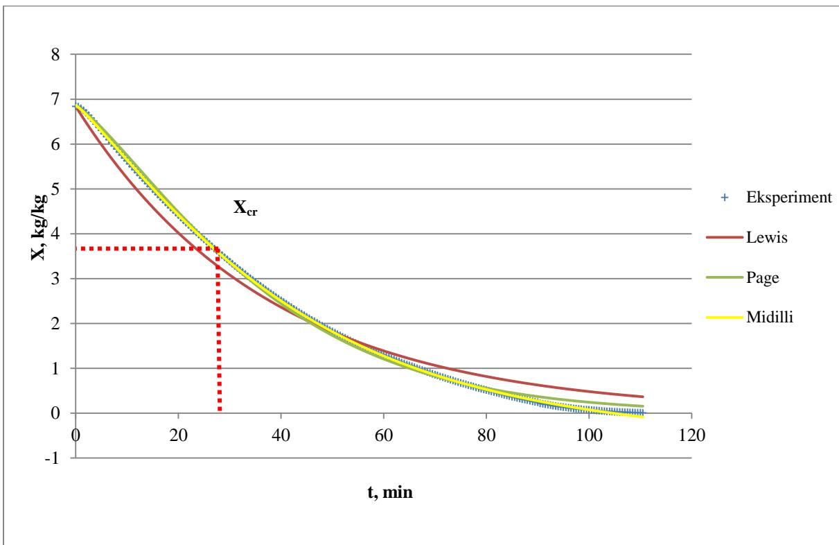
**Slika 43.** Grafički prikaz promjene sadržaja vlage uzorka mrkve s vremenom pri  $100\text{ }^{\circ}\text{C}$  te primjenjivost *Lewis*-ovog, *Page*-ovog i *Midilli-Kucuk*-ovog modela
