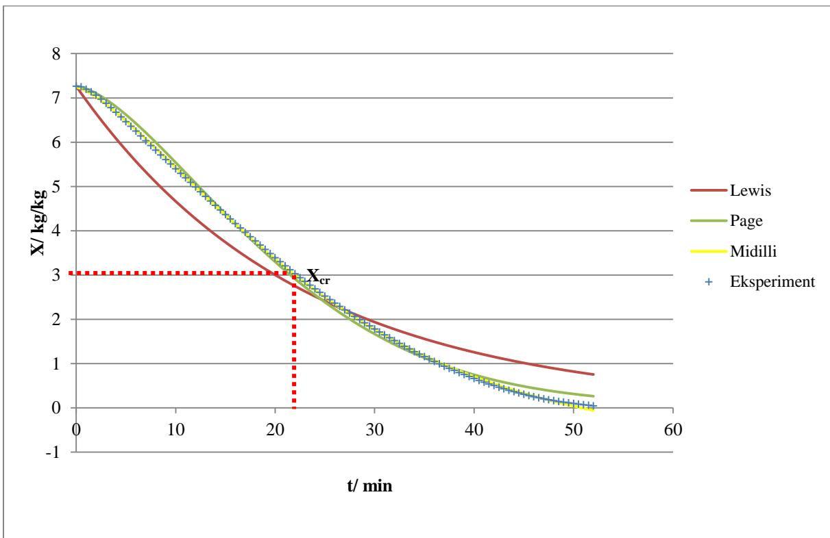
**Slika 32.** Grafički prikaz promjene sadržaja vlage s vremenom kod uzorka 4 pri  $100\text{ }^{\circ}\text{C}$  te primjenjivost *Lewis*-ovog, *Page*-ovog i *Midilli-Kucuk*-ovog modela
