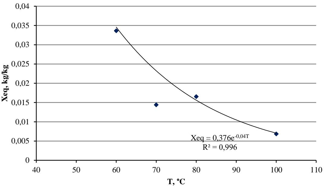
**Slika 26.** Grafički prikaz ovisnosti ravnotežnog sadržaja vlage  $X_{eq}$  o temperaturi sušenja  $T$  za uzorke celera
