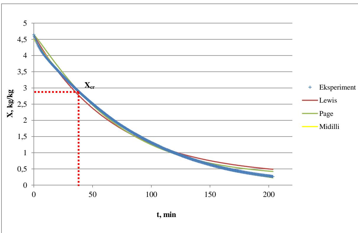
**Slika 73.** Grafički prikaz promjene sadržaja vlage uzorka lišća peršina s vremenom pri  $40\text{ }^{\circ}\text{C}$  te primjenjivost *Lewis*-ovog, *Page*-ovog i *Midilli-Kucuk*-ovog modela
