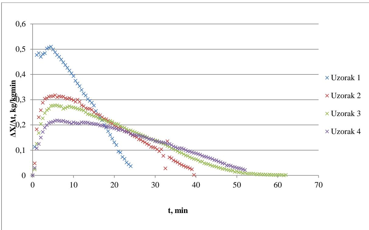
**Slika 28.** Grafički prikaz ovisnosti brzine isparavanja o vremenu za uzorce celera različite vrijednosti oplošja  $O$  pri temperaturi  $T= 100\text{ }^{\circ}\text{C}$
