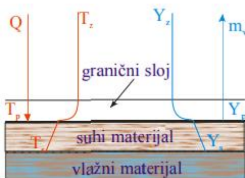
Slika 5. Prijenos tvari i topline u periodu padajuće brzine sušenja
