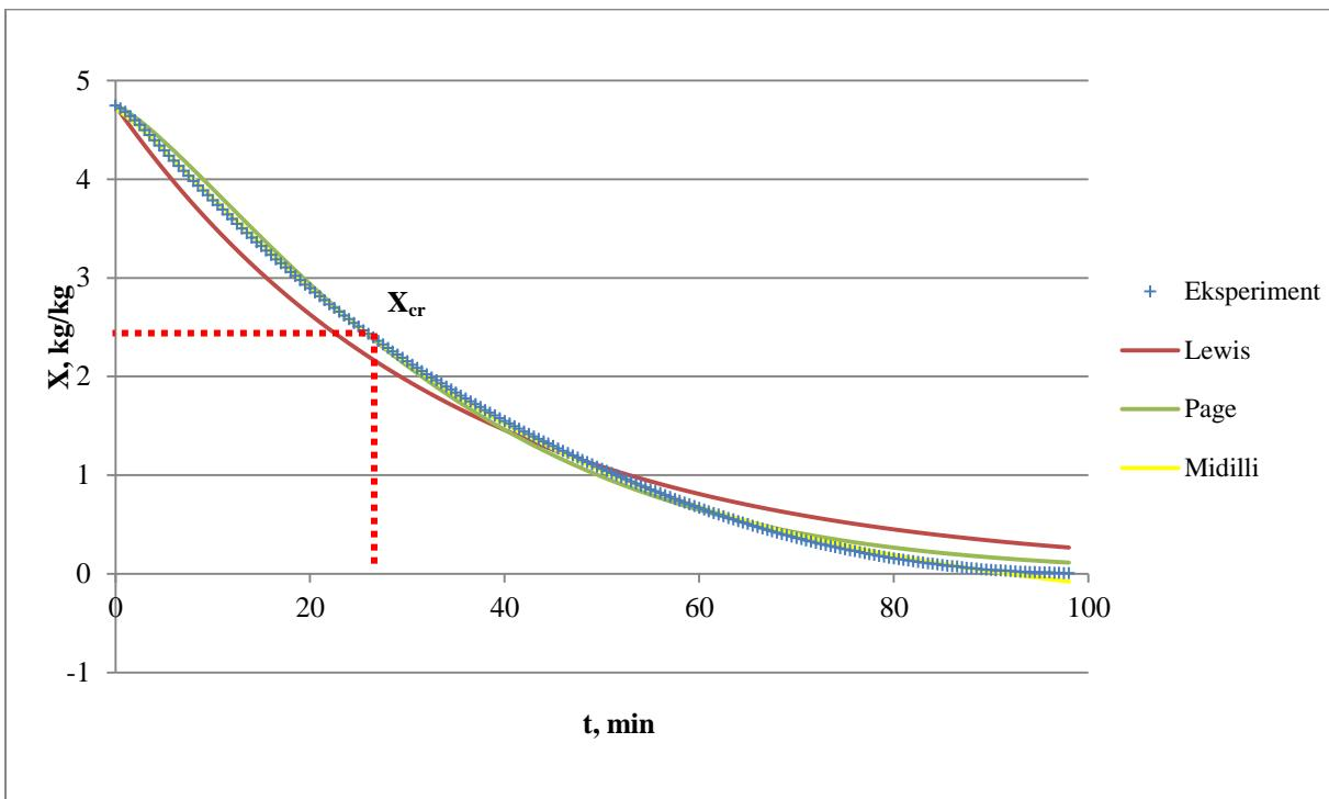
**Slika 65.** Grafički prikaz promjene sadržaja vlage uzorka korijena peršina s vremenom pri  $100\text{ }^{\circ}\text{C}$  te primjenjivost *Lewis*-ovog, *Page*-ovog i *Midilli-Kucuk*-ovog modela
