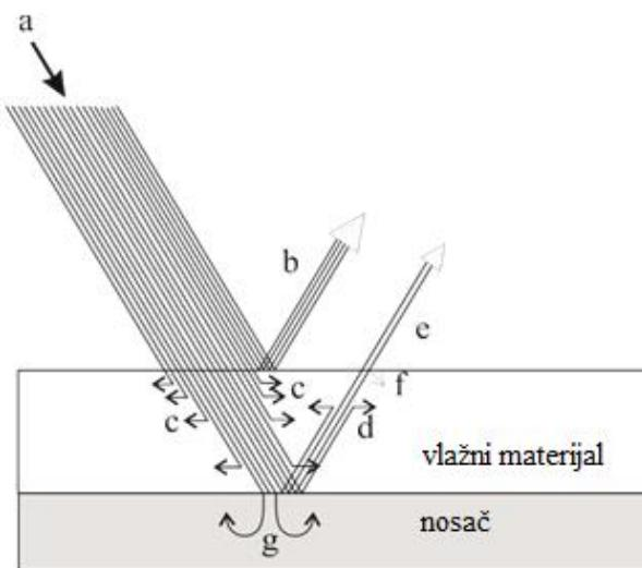
**Slika 7.** Apsorpcija elektromagnetskog zračenja pri sušenju vlažnog materijala<sup>13</sup>
