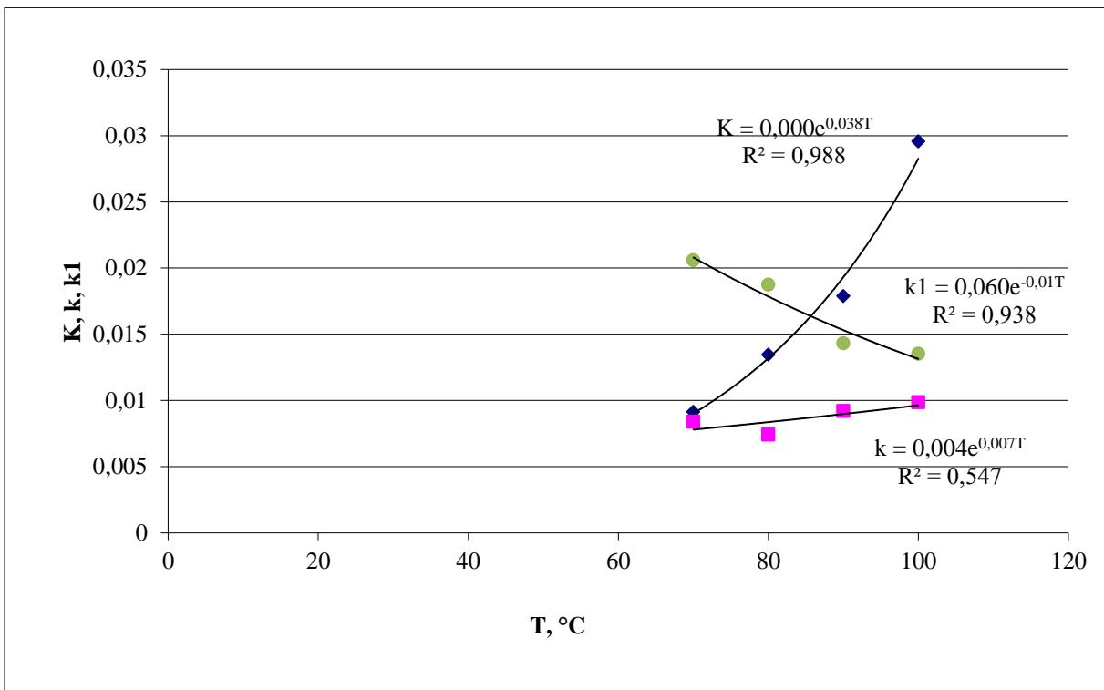
**Slika 66.** Grafički prikaz ovisnosti parametara *Lewis*-ovog ( $K$ ), *Page*-ovog ( $k$ ) i *Midilli-Kucuk*-ovog ( $k_1$ ) modela o temperaturi  $T$  za uzorke korijena peršina
