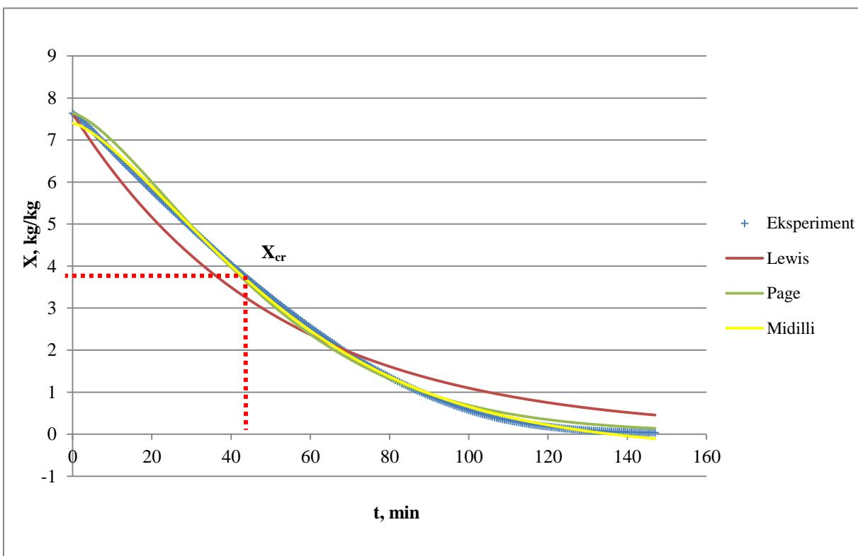
**Slika 20.** Grafički prikaz promjene sadržaja vlage uzorka celera s vremenom pri  $60\text{ }^{\circ}\text{C}$  te primjenjivost *Lewis*-ovog, *Page*-ovog i *Midilli-Kucuk*-ovog modela
