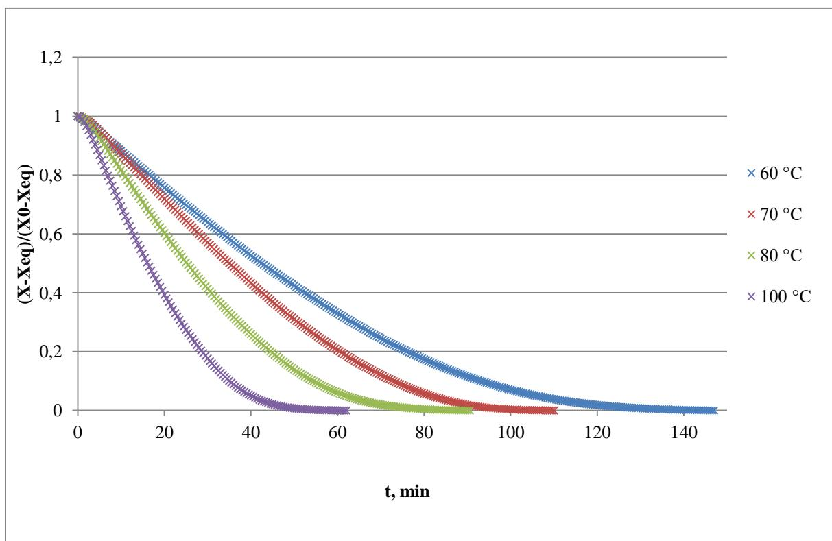
**Slika 18.** Grafički prikaz promjene sadržaja vlage uzorka celera s vremenom pri 60 °C, 70 °C, 80 °C i 100 °C
