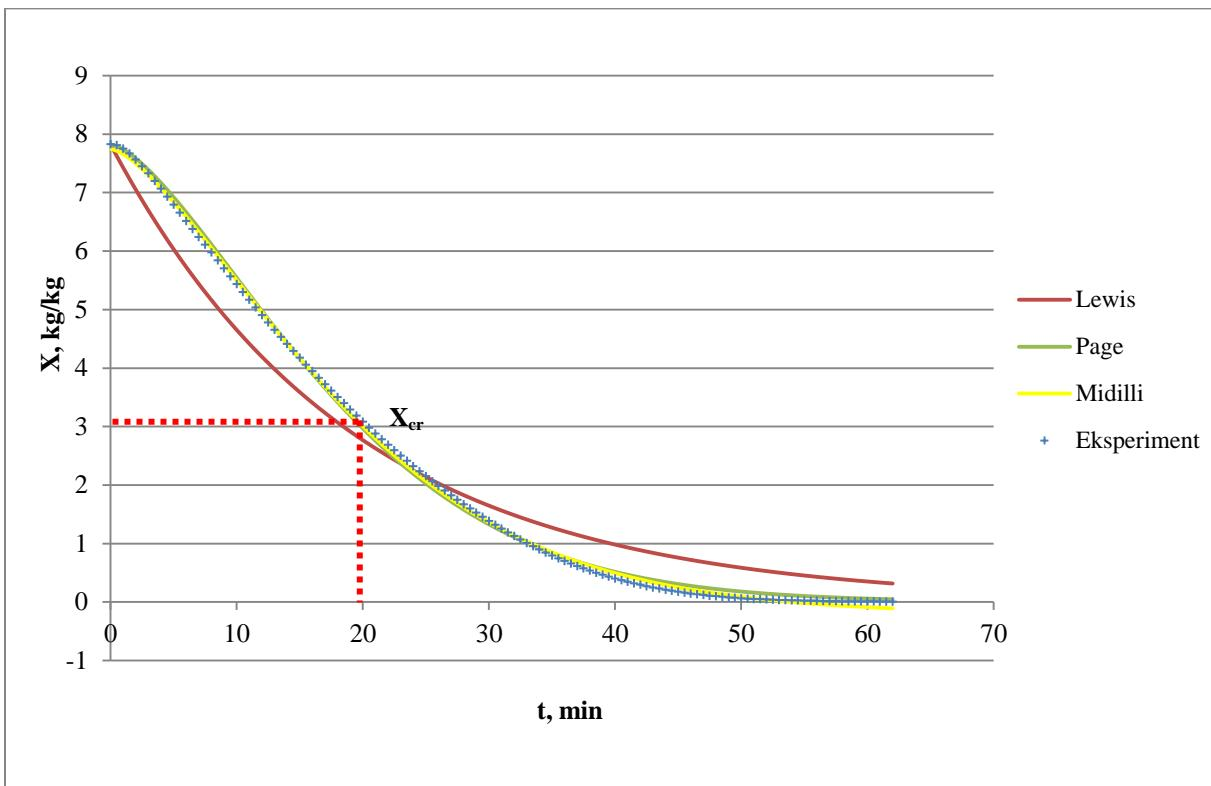
**Slika 23.** Grafički prikaz promjene sadržaja vlage uzorka celera s vremenom pri  $100\text{ }^{\circ}\text{C}$  te primjenjivost *Lewis*-ovog, *Page*-ovog i *Midilli-Kucuk*-ovog modela
