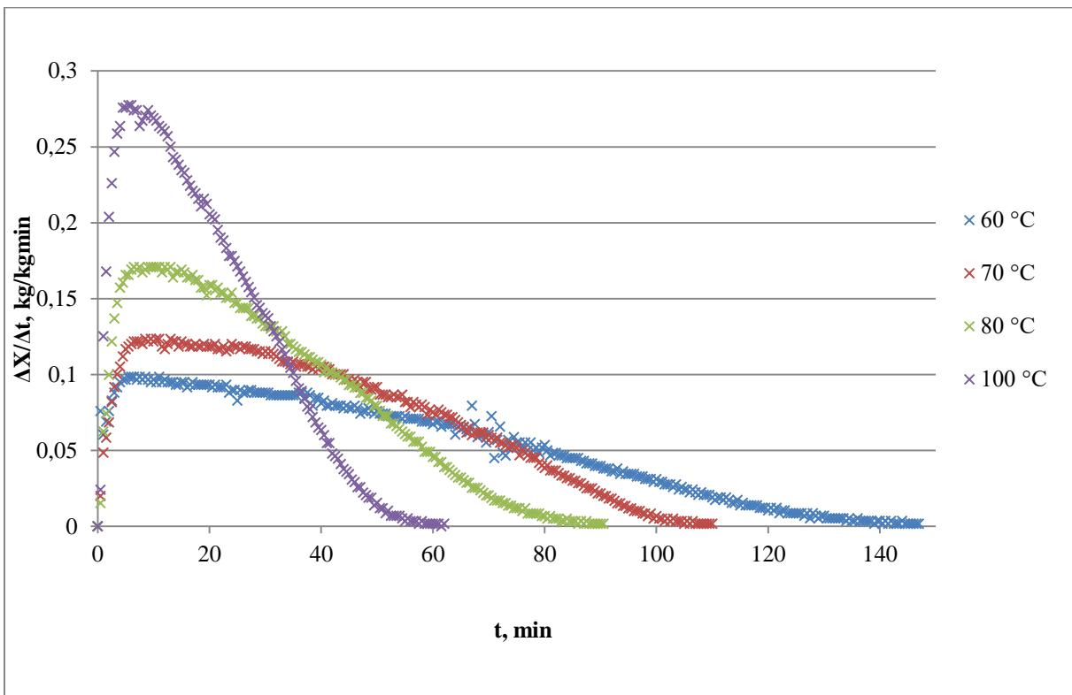
**Slika 19.** Grafički prikaz ovisnosti brzine sušenja uzorka celera o vremenu sušenja pri  $60\text{ }^{\circ}\text{C}$ ,  $70\text{ }^{\circ}\text{C}$ ,  $80\text{ }^{\circ}\text{C}$  i  $100\text{ }^{\circ}\text{C}$
