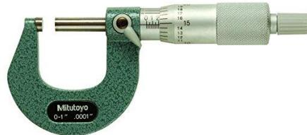
**Slika 17.** Mikrometar
