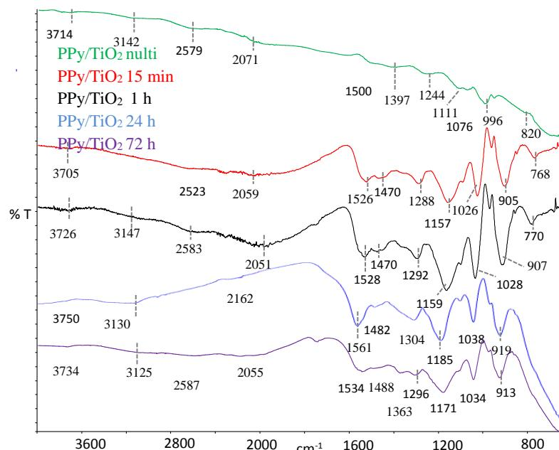
**Slika 21.** FTIR spektri sintetiziranih PPy/TiO<sub>2</sub>-1 kompozitnih fotokatalizatora modificiranih s 0,1 M NH<sub>4</sub>OH u vremenu od 15 min, 1, 15, 24, 48 i 72 sata
