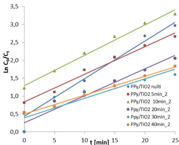
**Slika 29.** Funkcijska ovisnost  $\log(c_0/c)$  o vremenu fotokatalitičke razgradnje RR45 bojila kod Solarnog zračenja za PPy/TiO<sub>2</sub>-2 kompozitne fotokatalizatore
