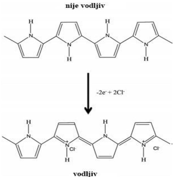
**Slika 7.** Reducirani (ne – vodljivi) i oksidirani (vodljivi) oblici polipirola kemijski sintetizirani pomoću  $\text{FeCl}_3$
