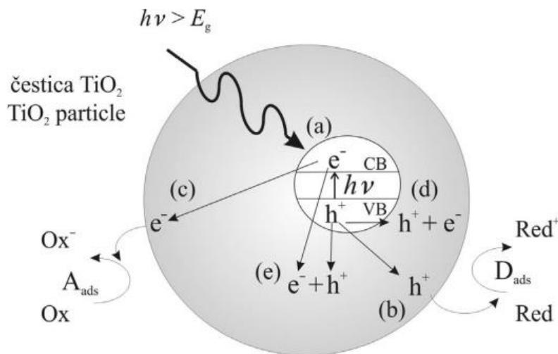
**Slika 2.** Glavni procesi u čestici poluvodiča  $\text{TiO}_2$ : (a) nastajanje para elektron - šupljina, (b) oksidacija adsorbirane molekule  $D$ , (c) redukcija adsorbirane molekule  $A$ , (d) rekombinacija na površini čestice, i (e) rekombinacija u unutrašnjosti čestice
