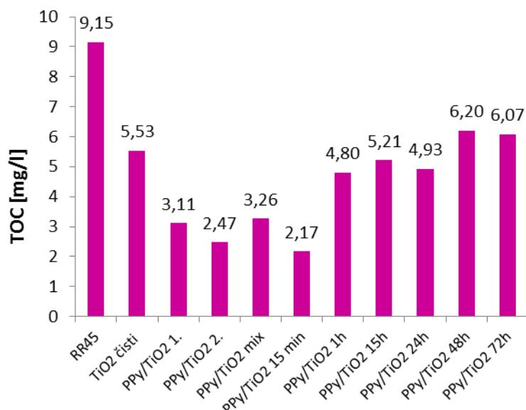
**Slika 25.** TOC vrijednosti nakon fotokatalize kod Solarnog zračenja za PPy/TiO<sub>2</sub>-1 kompozitne fotokatalizatore modificirane s 0,1M NH<sub>4</sub>OH u usporedbi s čistim TiO<sub>2</sub>
