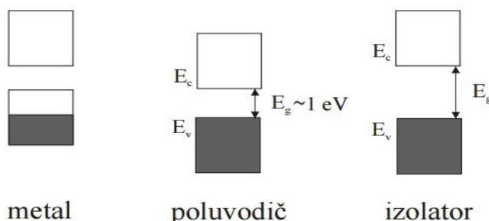
**Slika 5.** Elektronske vrpce metala, poluvodiča i izolatora
