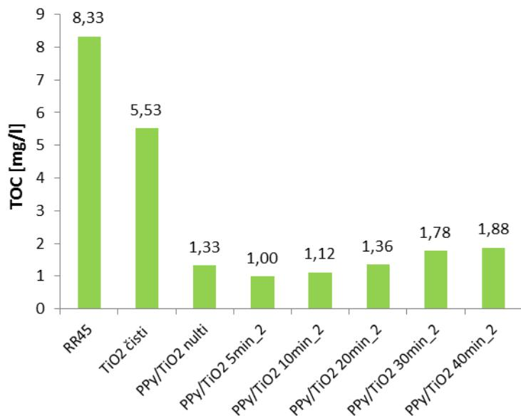
**Slika 30.** TOC vrijednosti nakon fotokatalize kod Solarnog zračenja za PPy/TiO<sub>2</sub>-2 kompozitne fotokatalizatore modificirane s 0,01M NH<sub>4</sub>OH u usporedbi s čistim TiO<sub>2</sub>
