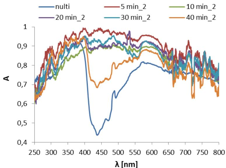
**Slika 27.** UV-Vis spektri absorbancije za PPy/TiO<sub>2</sub>-2 kompozitne fotokatalizatore modificirane s 0,01 M NH<sub>4</sub>OH u vremenu od 5, 10, 15, 20, 30 i 40 minuta
