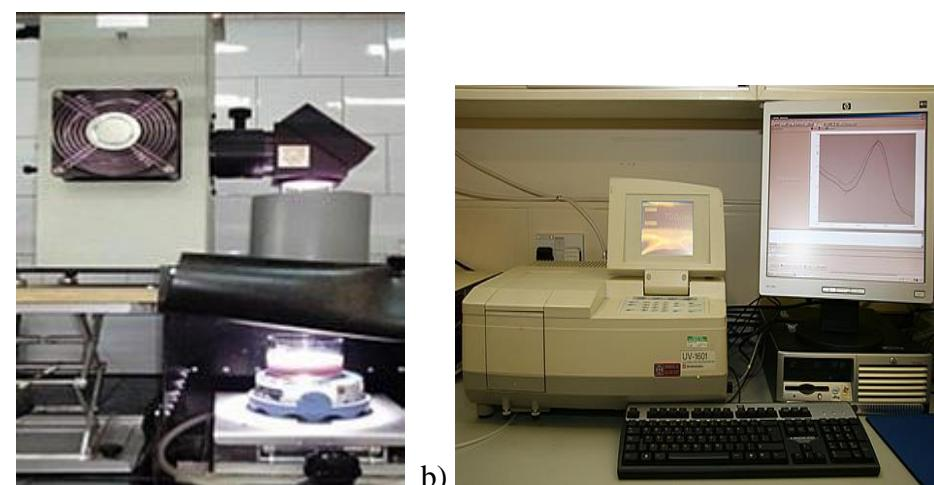
**Slika 19.** a) Lampa za solarno zračenje i b) UV/Vis spektrofotometar
