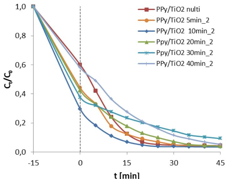
**Slika 28.** Koncentracija RR45 bojila ovisno o vremenu fotokatalitičke razgradnje kod Solarnog zračenja za PPy/TiO<sub>2</sub>-2 kompozitne fotokatalizatore modificirane s 0,01 M NH<sub>4</sub>OH u trajanju od 5, 10, 20, 30 i 40 minuta ( $\gamma_{RR45}=30 \text{ mg/l}$ ,  $\gamma_{\text{kat}}=1 \text{ g/l}$ , pH = 6,5)
