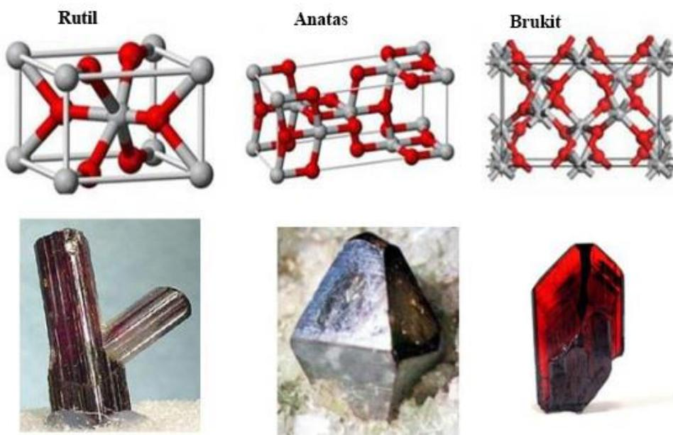
Slika 3. Kristalni oblici  $\text{TiO}_2$  – rutil, anatas i brukit [22]
