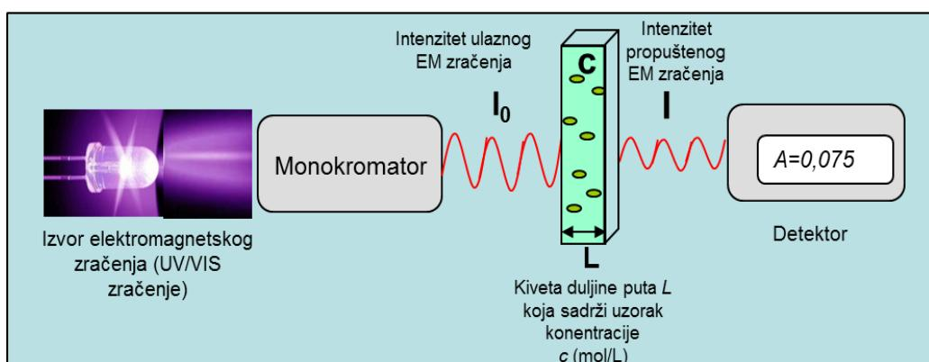
Slika 13. Shema principa rada UV/Vis spektrofotometra
