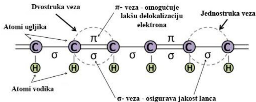
**Slika 4.** Pojednostavljeni shematski prikaz konjugiranog „kostura“ (lanac koji sadržava naizmjenične jednostrukе i dvostrukе veze)
