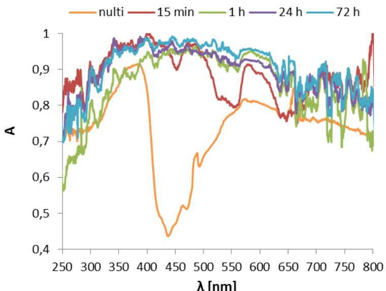
**Slika 22.** UV-Vis spektri absorbancije za PPy/TiO<sub>2</sub>-1 kompozitne fotokatalizatore modificirane s 0,1 M NH<sub>4</sub>OH u vremenu od 15 min, 1, 15, 24, 48 i 72 sata
