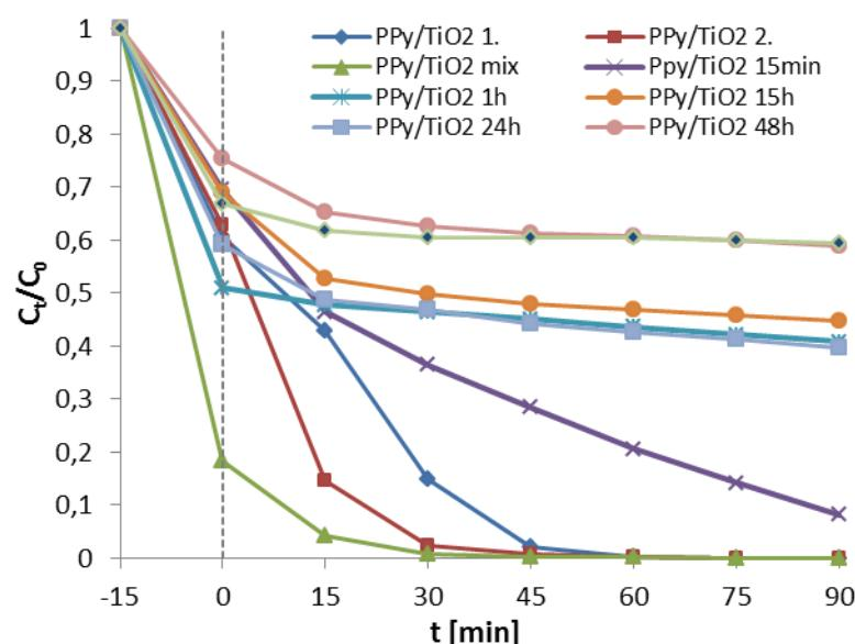
**Slika 23.** Koncentracija RR45 bojila ovisno o vremenu fotokatalitičke razgradnje kod Solarnog zračenja za PPy/TiO<sub>2</sub>-1 kompozitne fotokatalizatore modificirane s 0,1 M NH<sub>4</sub>OH u vremenu od 5 min, 1, 15, 24 i 48 sati
