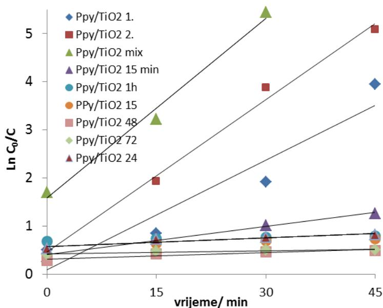
**Slika 24.** Funkcijska ovisnost log ( $c_0/c$ ) o vremenu fotokatalitičke razgradnje RR45 bojila kod Solarnog zračenja za PPy/TiO<sub>2</sub>-1 kompozitne fotokatalizatore
