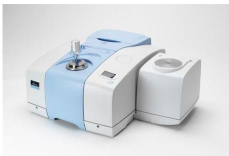
Slika 15. FTIR spektrometar
