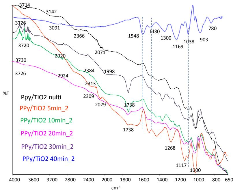
Slika 26. FTIR spektri sintetiziranih PPy/TiO<sub>2</sub>-2 kompozitnih fotokatalizatora modificiranih s 0,01 M NH<sub>4</sub>OH u vremenu od 5, 10, 15, 20, 30 i 40 minuta
