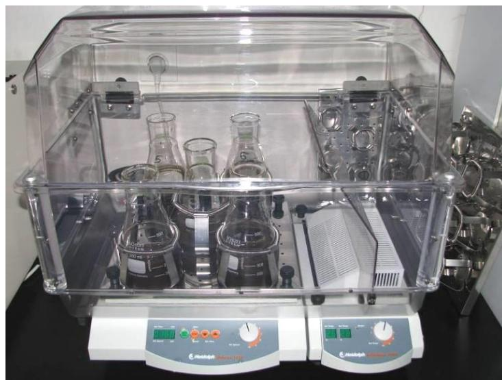
Slika 3.1. Rotacijska termostatirana tresilica.
