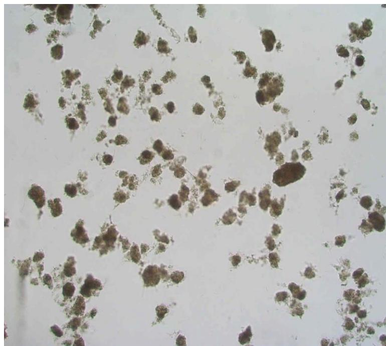
Slika 4.15. Mikrofotografija aktivnog mulja u 24. satu provedbe procesa biorazgradnje farmaceutske otpadne vode,  $P = 100\times$  u P1-1.
