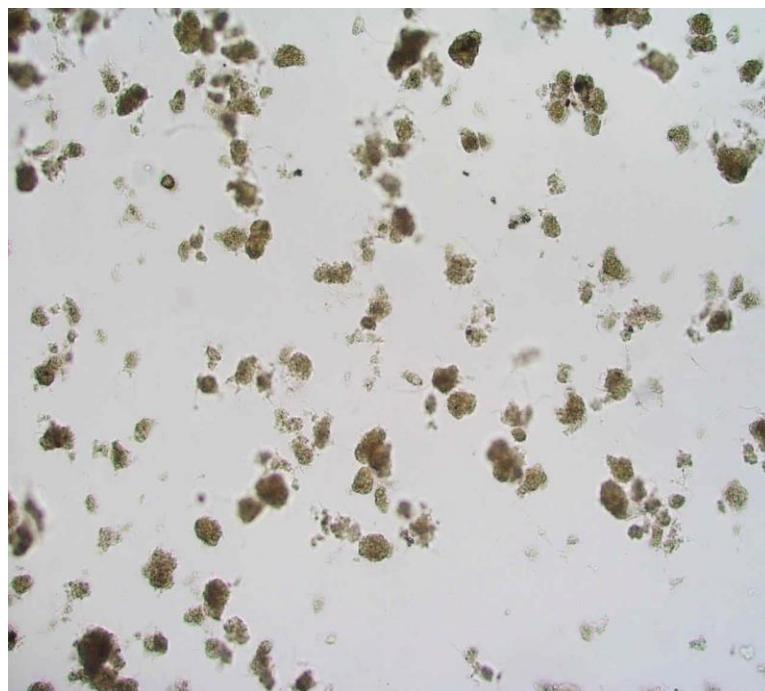
Slika 4.13. Mikrofotografija pahuljica aktivnog mulja na početku provedbe procesa biorazgradnje farmaceutske otpadne vode,  $P = 100\times$  u P1-1.
