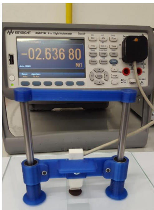
Slika 3.13. Uređaj i sonda za mjerenje električnog otpora
