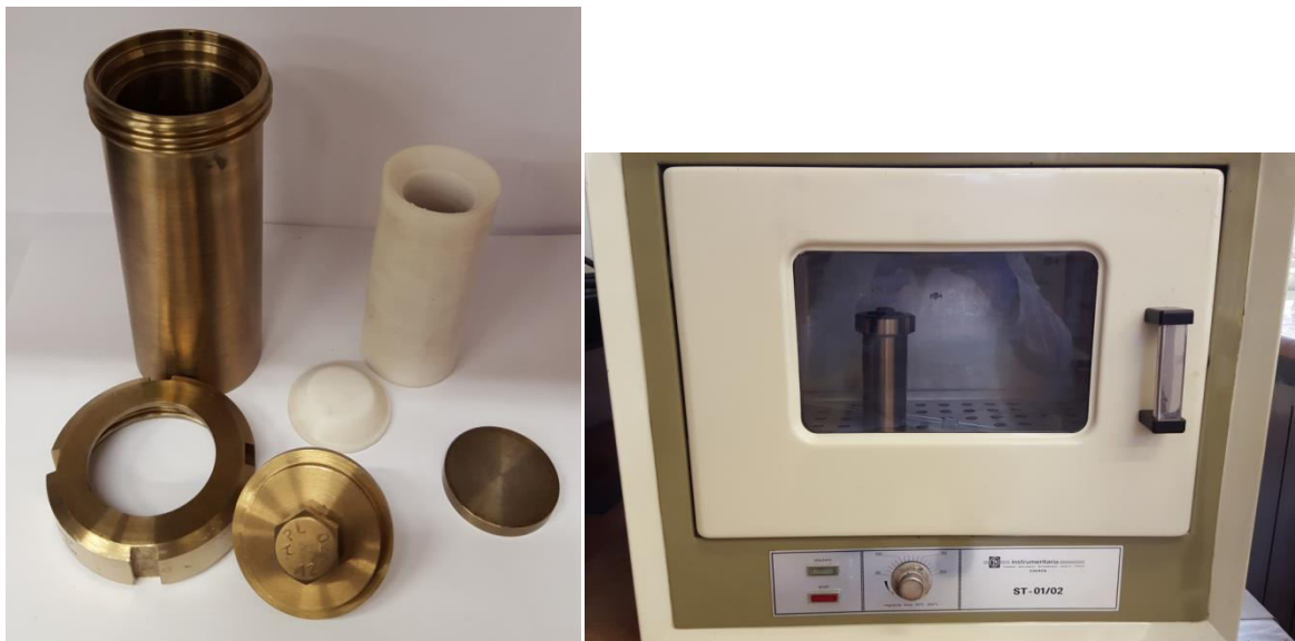
Slika 3.4. Sastavni dijelovi autoklava i sušionik u kojem je autoklav zagrijavan.
