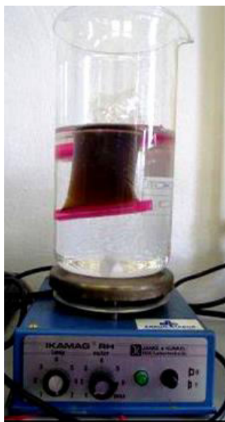
Slika 3.2. Proces dijalize otopine grafenova oksida, GO
