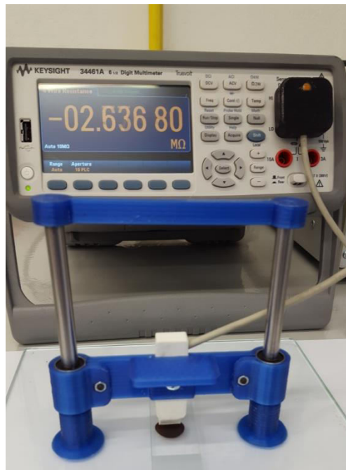
Slika 3.13. Uređaj i sonda za mjerenje električnog otpora
