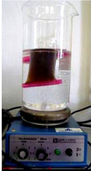
Slika 3.2. Proces dijalize otopine grafenova oksida, GO
