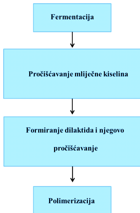
Slika 2. Shematski prikaz dobivanja polilaktida 6
