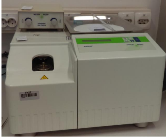
Slika 19. DSC (A) uređaj Mettler Toledo DSC 823e i (B) preša
