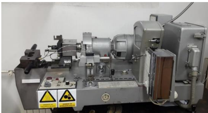
Slika 19. Uređaj za zamješavanje u talini, Brabender gnjetilica
