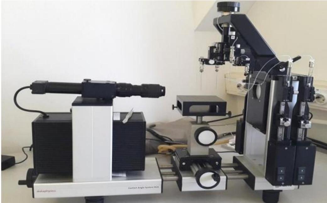
Slika 20. Goniometar, DataPhysics OCA 20 Instrument
