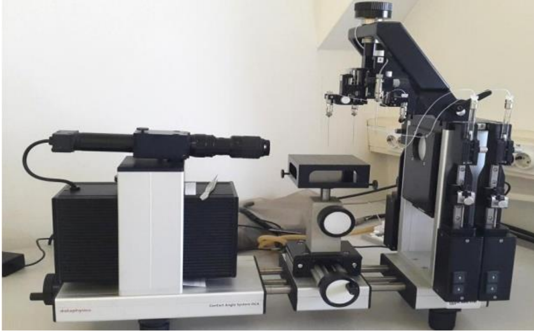
Slika 20. Goniometar, DataPhysics OCA 20 Instrument
