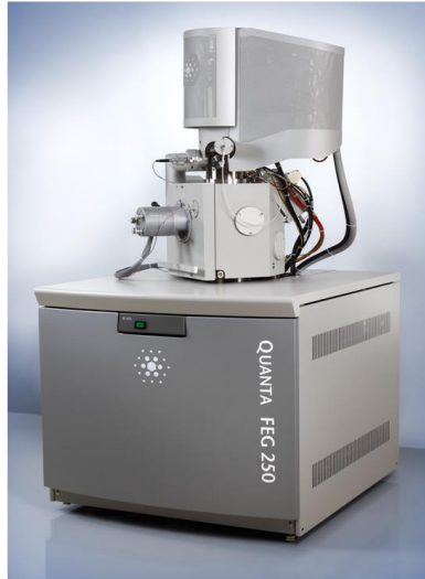
Slika 18. SEM mikroskop QUANTA 250, FEI [28]
