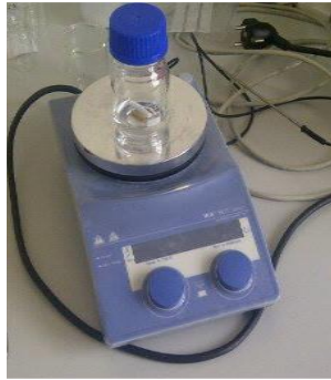
Slika 14. Polimerna otopina PCL-a na magnetskoj miješalici
