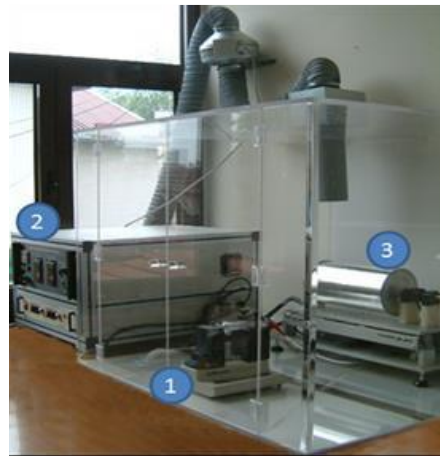
Slika 17. Uređaj za elektroispredanje na Tekstilno-tehnološkom fakultetu u Zagrebu
