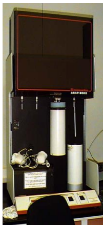
Slika 19. Uređaj za određivanje raspodjele volumena pora, ASAP 2000
