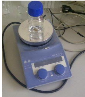
Slika 14. Polimerna otopina PCL-a na magnetskoj miješalici
