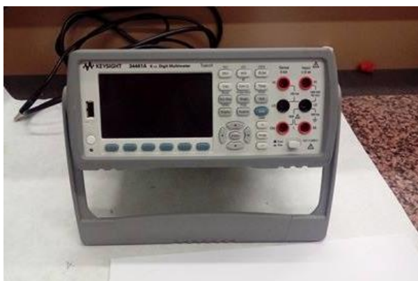
Slika 3.3. Uređaj za mjerenje električnog otpora Keysight 34461 6 1/2 Digit Multimeter
