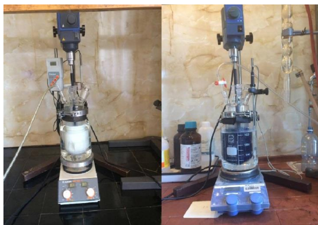
Slika 3.2. Polimerizacija PEDOT/TiO 2 na početku i nakon 96 h
